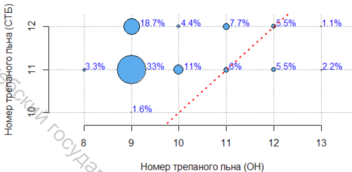
Рисунок 5 – Совместное распределение номеров длинного трепаного льноволокна, определенных в соответствии с действующим стандартом (СТБ) и отраслевыми нормами (ОН)
