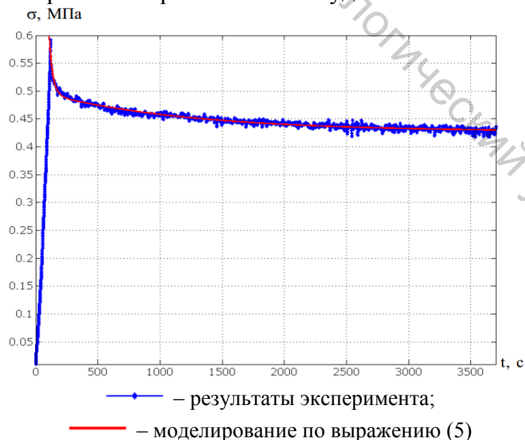
Рисунок 4 – Кривая релаксации напряжений трикотажного полотна варианта 2 при постоянном удлинении \varepsilon = 2
