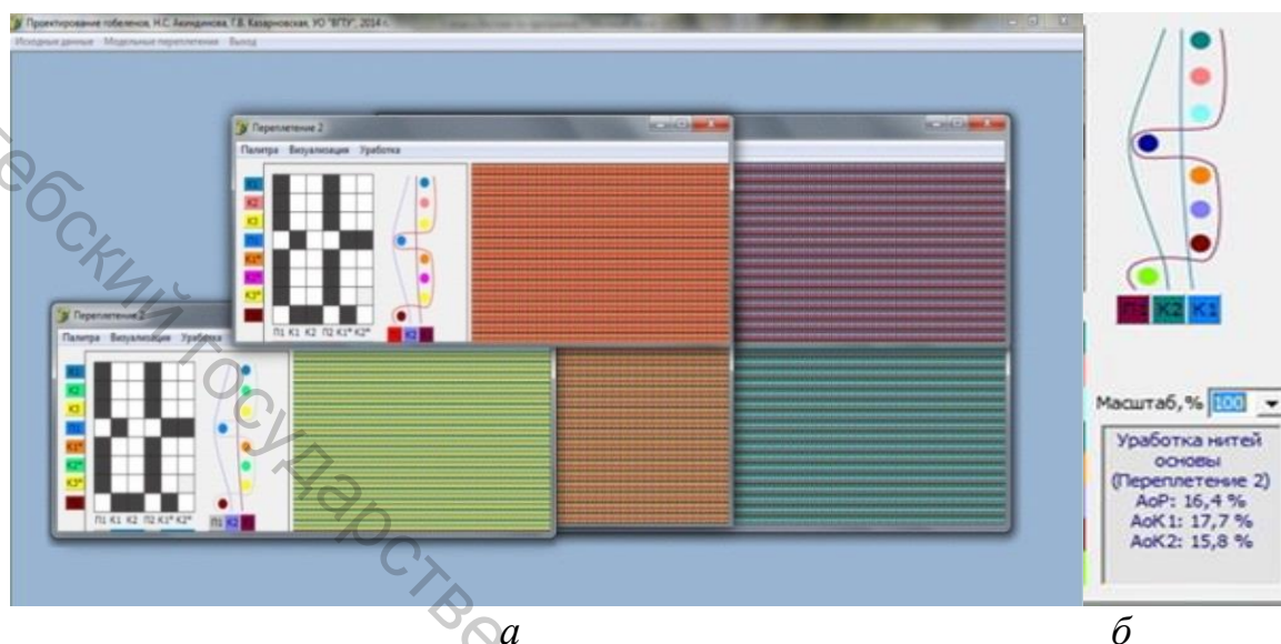
Рисунок 7 – Многооконный интерфейс с вариантами цветовых решений разрабатываемой гобеленовой ткани (а) и окно с расчётом уработки по сводам (б)
