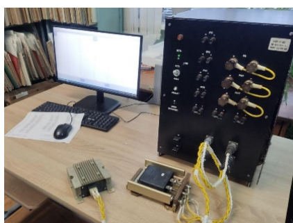
Рис. 17. Автоматизированный стенд САП-3-03 предназначен для автоматизированной проверки преобразователей напряжения постоянного тока ПН24/12 М-1 и ПНПТ 14/28
