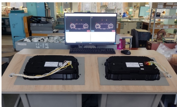
Рис. 12. Автоматизированный стенд САП-1-03 для автоматизированной проверки измерительно-информационных приборов с матричной и стрелочной формой отображения информации
