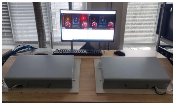
Рис. 10. Автоматизированный стенд САП-1-01 для проверки печатной платы щитка приборов ЩП8155 и ЩП8156
