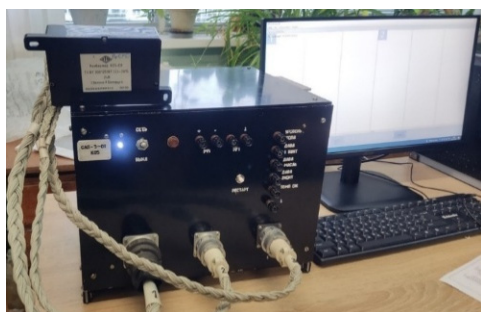
Рис. 15. Автоматизированный стенд САП-3-01 предназначен для автоматизированной проверки конвертера K05
