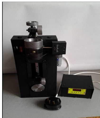
Рисунок 2 - Станок для полировки волок обычного исполнения
