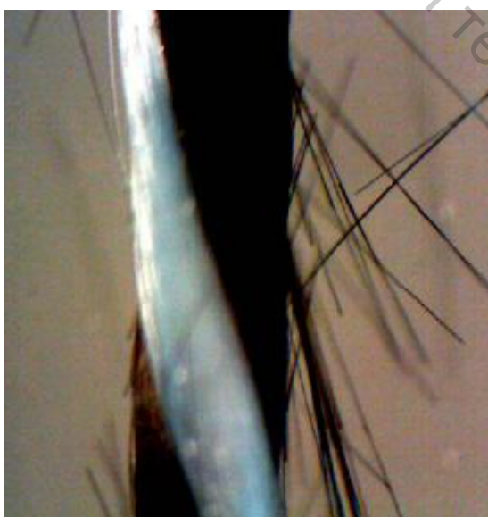
Рисунок 3 – Структура КУН, полученной на тростильно-крутильной машине
