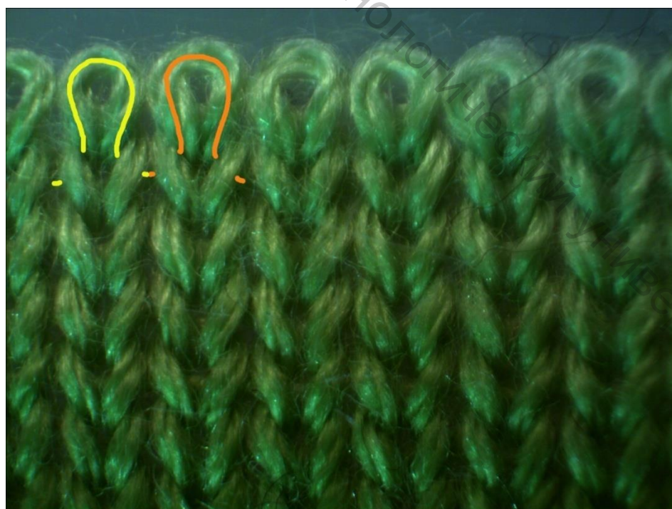
Рисунок 3.7 – Кулирная гладь с очищенным последним рядом
