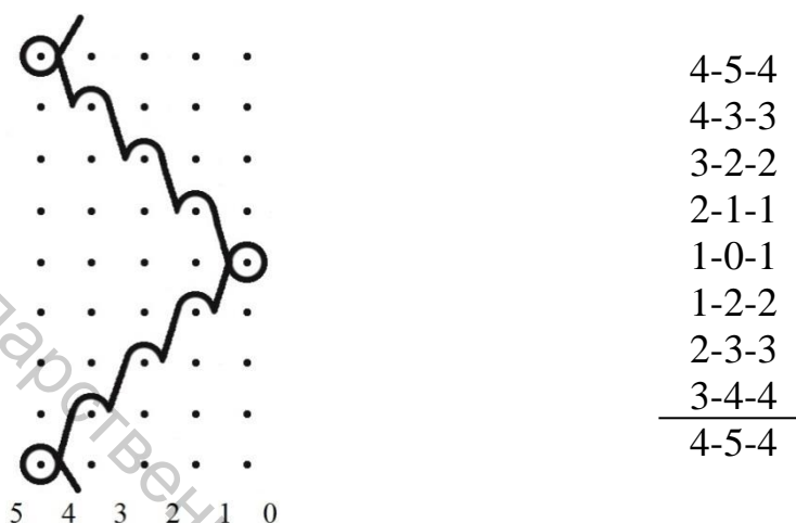
Рисунок 3.40 – Одинарный восьмирядный триковый атлас: a – графическая запись восьмирядного трикового атласа; б – аналитическая запись восьмирядного трикового атласа.
