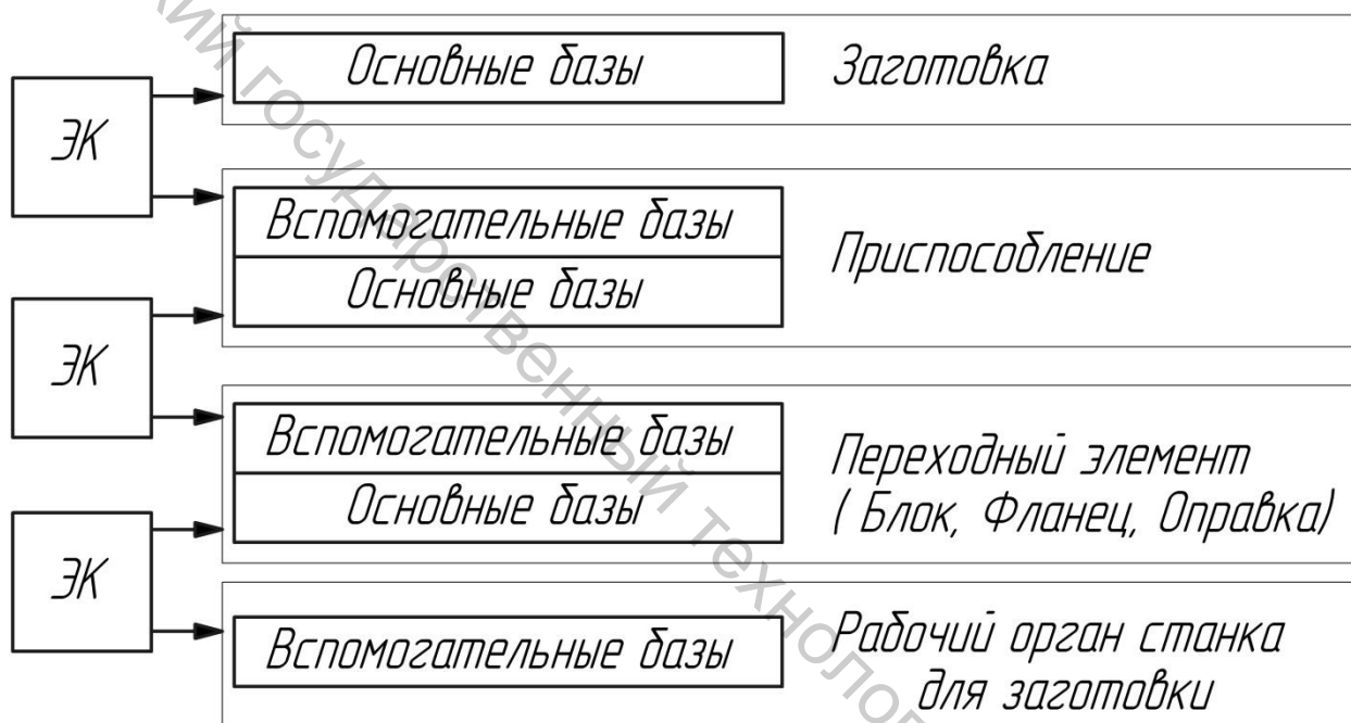
Рисунок 2.1 – Структурная схема комплектования приспособлений для установки заготовок на станках (ЭК – элементы крепления)
