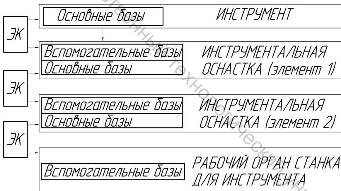
Рисунок 3.1 – Структурная схема комплектования приспособлений для установки инструмента на металлорежущих станках
