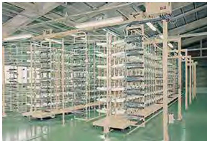
Рисунок 3.45 – Шпулярник TCR-НТ тележечного типа
