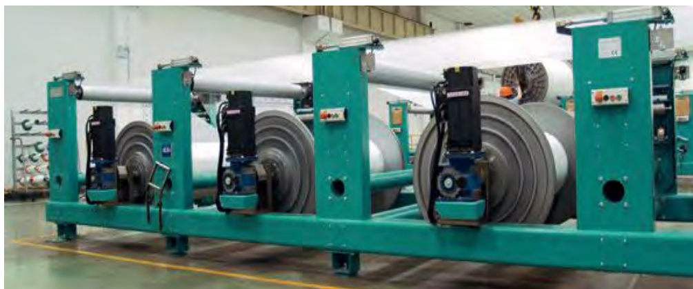
Рисунок 3.14 – Сервопривод обеспечивает постоянное натяжение нитям основы, сматываемым со сновальных валиков
