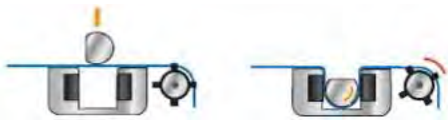
Рисунок 4.10 – Принцип зажима Б с обмоткой
