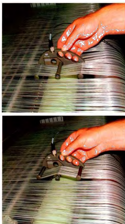
Рисунок 5.38 – Датчики тягового усилия основы: а – односторонний датчик; б – двухсторонний датчик
