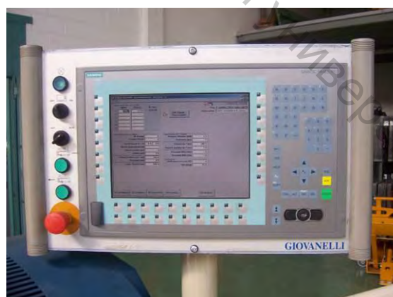
Рисунок 2.107 – Панель управления машиной (а) и вид табло системы управления с визуализацией режима работы «Снование» (б)
