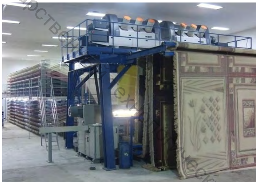
Рисунок 5.110 – Ткацкий станок для производства жаккардовых ковров
