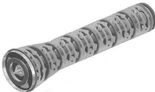
Рисунок 2.101 – Дисковая компоновка сновального барабана
