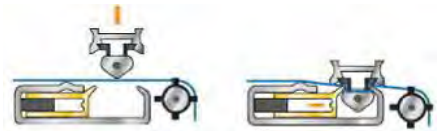
Рисунок 4.9 – Принцип зажима А без обмотки
