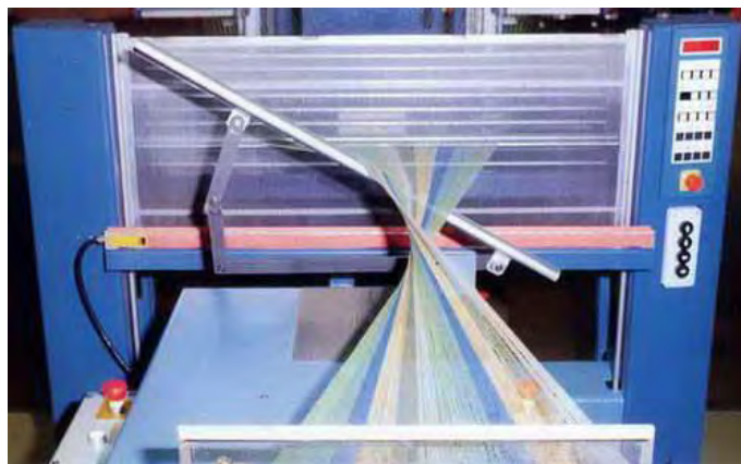
Рисунок 2.98 – Поворот ленты для симметричного манера цвета основы
