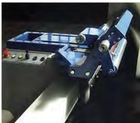
Рисунок 2.110 – Положения суппортного столика и стабилизирующего цилиндра относительно плоскости наматывания ленты
