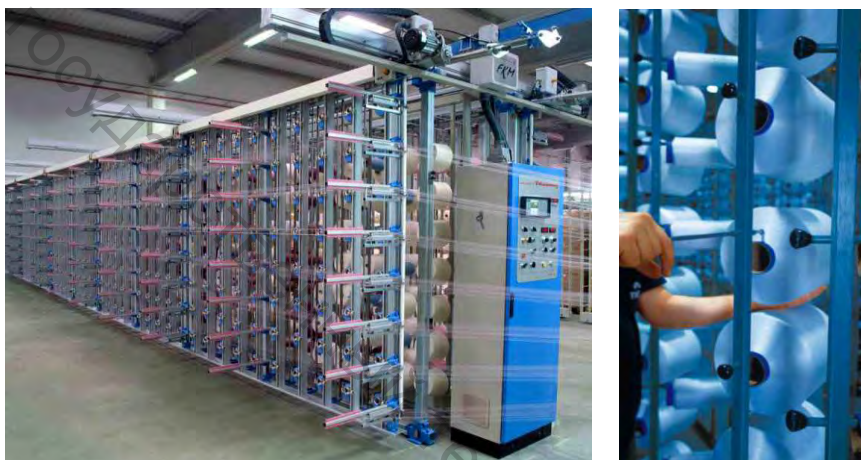
Рисунок 2.84 – Внешний вид и система загрузки шпулярика FKU
