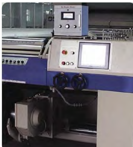
Рисунок 3.48 – Система T-MDS компьютерного контроля параметров с полноцветным графическим дисплеем
