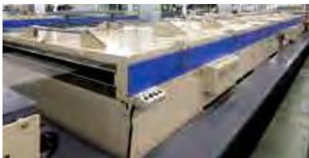
Рисунок 3.20 – Изолированные сушильные камеры горячего воздуха
