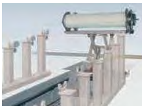
Рисунок 3.39 – Система BL для подвоза и установки сновальных валиков
