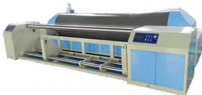
Рисунок 2.137 – Внешний вид сновальной машины JT231 и перевивочный механизм
