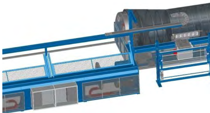
Рисунок 2.94 – Расположение перевивочного устройства на машине M-Warp
