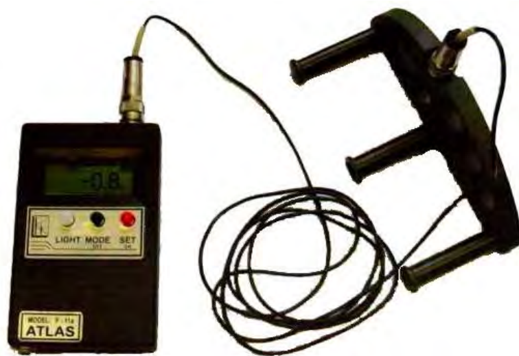
Рисунок 5.37 – Устройство ATLAS F-11 с датчиком основы
