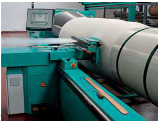
Рисунок 2.18 – Механизм суппорта с лазерным устройством
