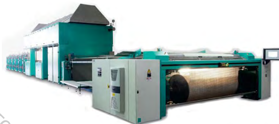
Рисунок 3.7 – Шлихтовальная машина ISOSIZE для штапельной пряжи
