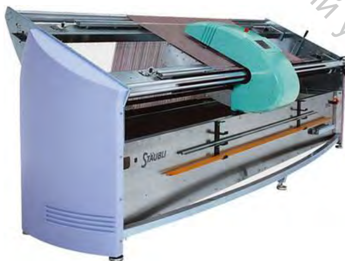
Рисунок 4.11 – Система OPAL для разделения нитей основы
