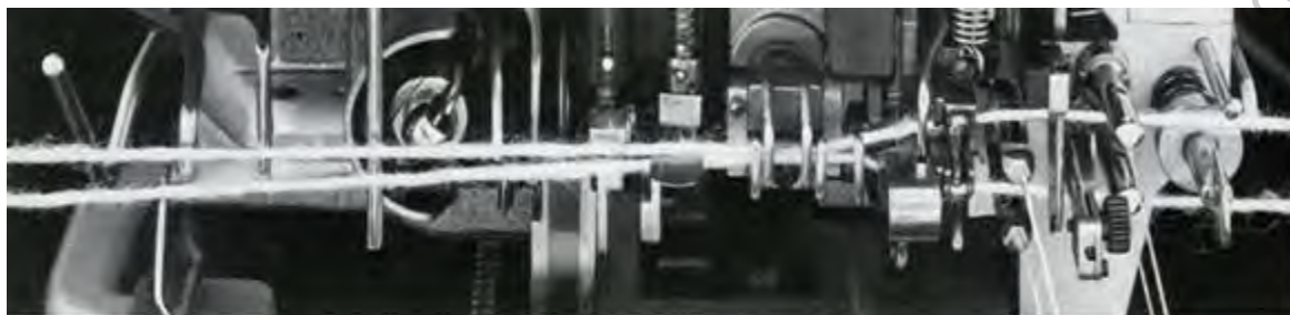
Рисунок 4.37 – Процесс связывания двух отобранных нитей
