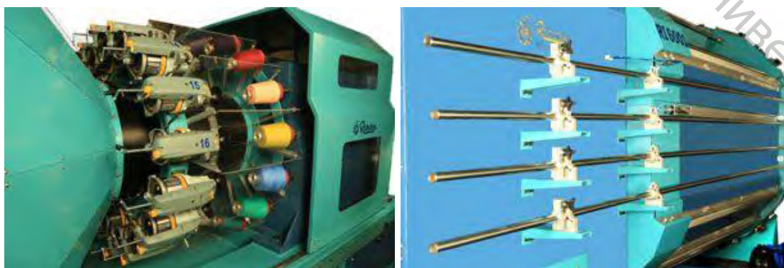
Рисунок 2.118 – Вращающийся тип шпулярника и система аккумуляторов секционной машины RI 6001
