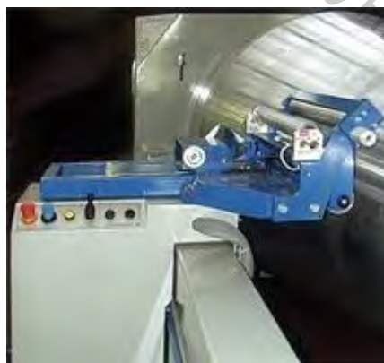
Рисунок 2.110 – Положения суппортного столика и стабилизирующего цилиндра относительно плоскости наматывания ленты
