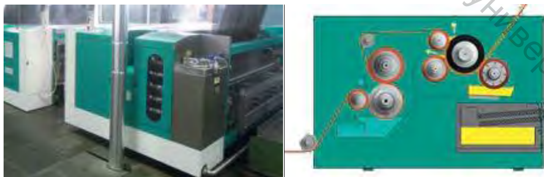
Рисунок 3.3 – Шлихтовальная ванна типа HSB с запатентованной системой нанесения шлихты (уровня приклея) и с предварительным увлажнением теплой водой
