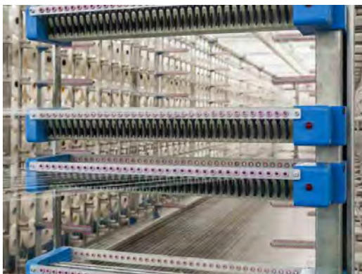
Рисунок 2.86 – Система контроля обрыва нити Comsat IR
