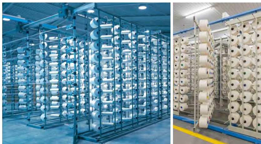
Рисунок 2.83 – Внешний вид и система загрузки шпулярика FEU-R
