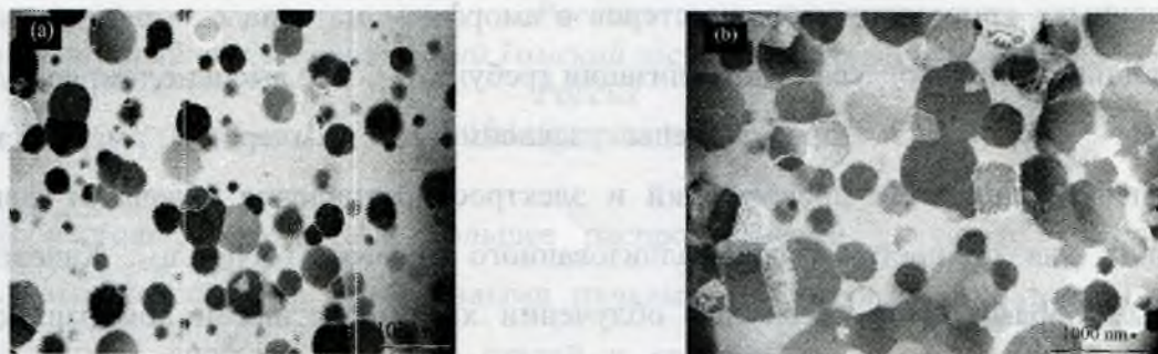
Рисунок 1. Структура аморфно-кристаллических образцов сплава Ti_{40.7}Hf_{9.5}Ni_{44.8}Cu_5 с 30 и 85 % кристаллической фазы
