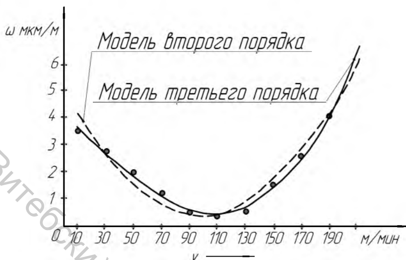
Рис. 6.3. Зависимость удельной интенсивности изнашивания от скорости резания (результаты эксперимента и построение модели)'
