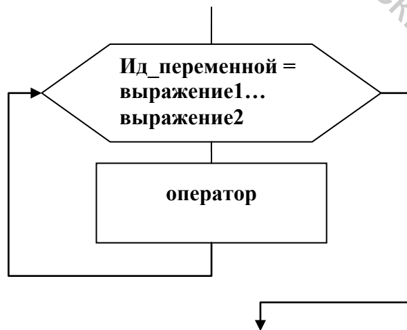
Рисунок 6 – Блок-схема цикла с параметром
