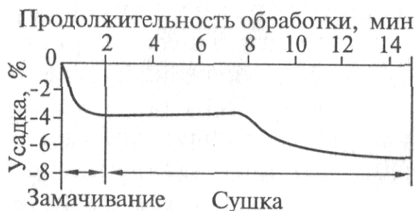
Рисунок 3.36 – Циклограмма изменения усадки ткани во времени при замачивании и сушке
