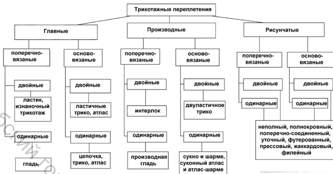
Рисунок 2.47 – Классификация трикотажных переплетений
