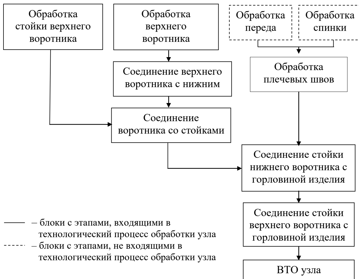
Рисунок 4.1 – Блок-схема обработки воротника мужской сорочки с отрезной стойкой и соединения его с горловиной
