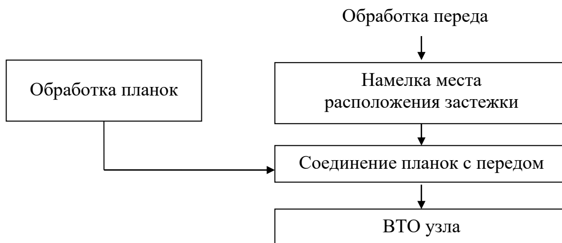
Рисунок 3.1 – Блок-схема обработки застежки планками, не доходящими до низа, с втачными концами
