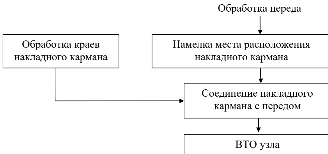
Рисунок 1.1 – Блок-схема обработки накладного кармана
