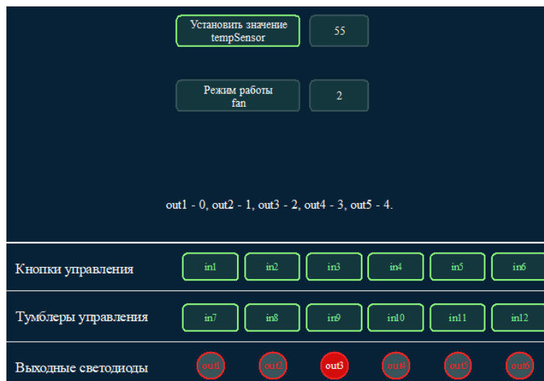
Рисунок 4.29 – Режим работы вентилятора при температуре 55 °С
