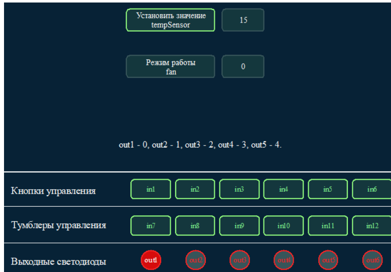
Рисунок 4.28 – Режим работы вентилятора при температуре 15 °С
