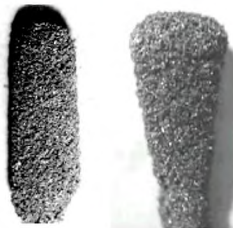
Рисунок 2 – Титановые образцы, полученные методом спекания-плавления в виде цилиндрического стержня и конуса: диаметр цилиндра \approx 7,5 мм, диаметр основания конуса \approx 7 мм
