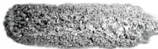
Рисунок 3 – Спечено/переплавленная структура титанового стержня (шлиф)
