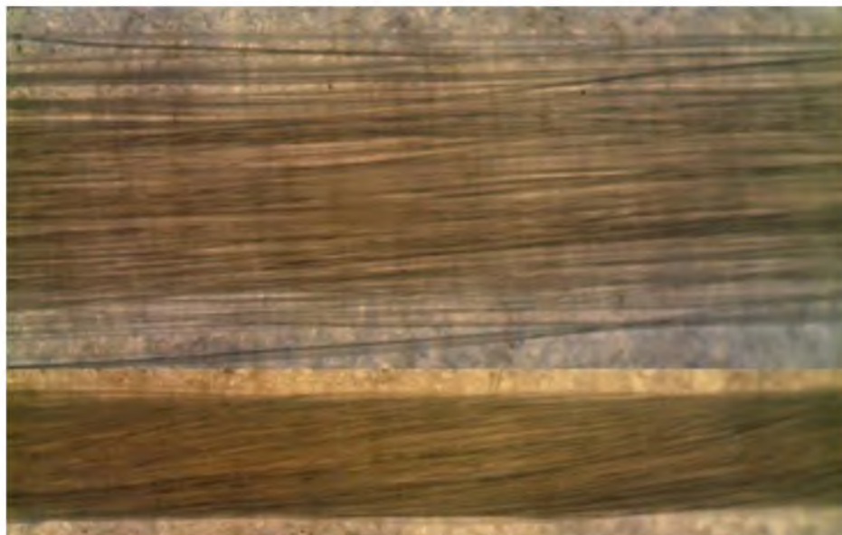
Рисунок 1 – Внешний вид нити СВМПЭ 66 текс до и после кручения Figure 1 – View of UHMWPE thread 66 tex before and after twisting
