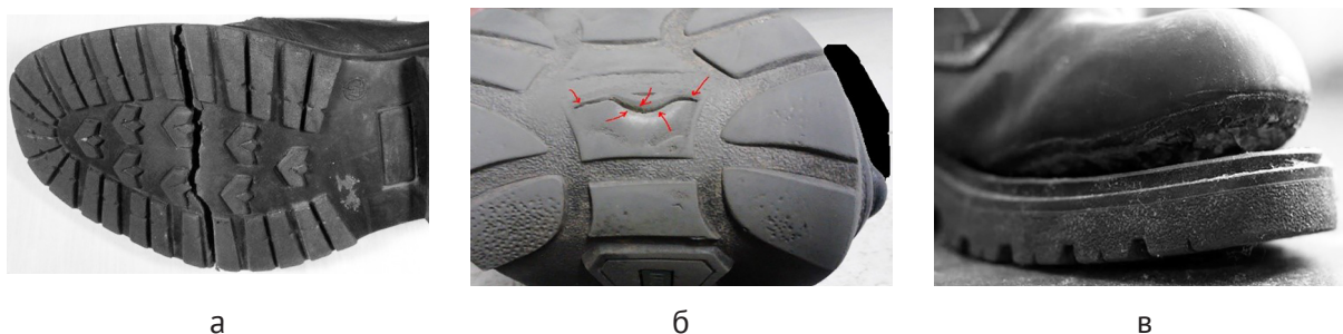
Рисунок 2 – Виды дефектов низа обуви: а – трещина подошвы; б – механические повреждения – прокол; в – отклей подошвы обуви
