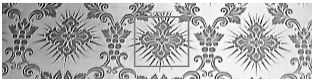
Рисунок 5 – Результат обработки изображения методом TM_SQDIFF
