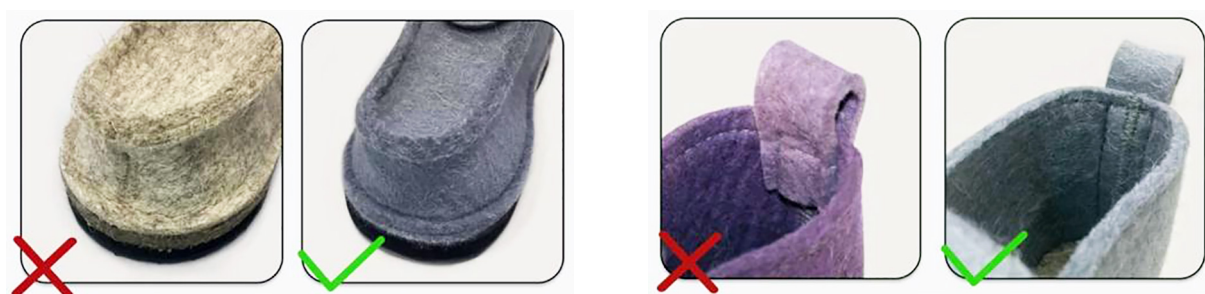
Рисунок 6 – Конструктивный способ формообразования верха обуви из войлока
