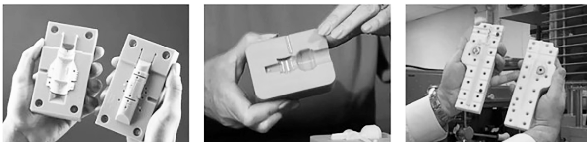
Рисунок 3 – Примеры пресс-форм, напечатанных на 3D-принтере
