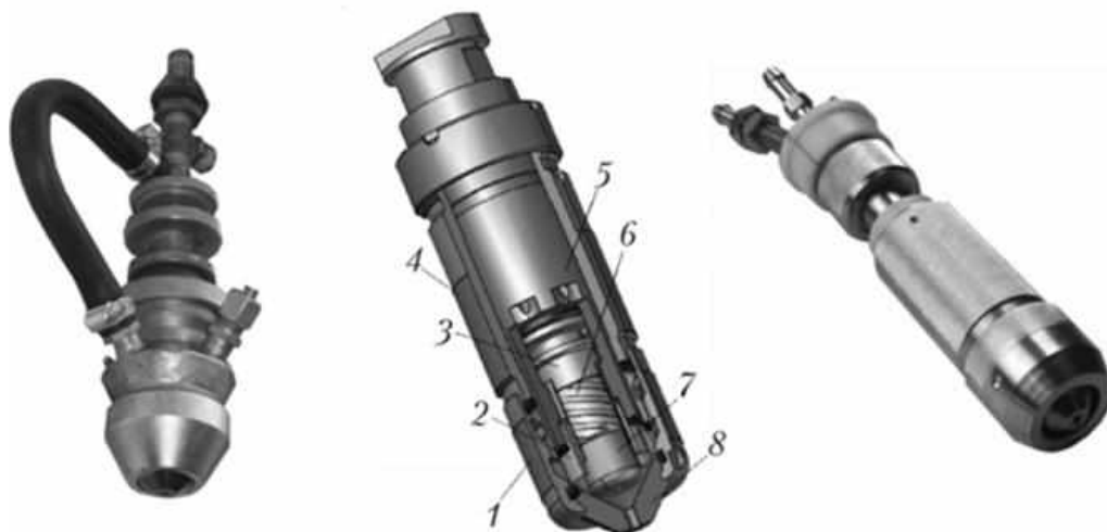
Рисунок 5.2 – Плазматроны для резки и их устройство: 1 – гайка сопла; 2 – изоляционная втулка; 3 – электронный узел; 4 – кожух; 5 – фторопластовый корпус; 6 – механизм закрутки воздушного потока; 7 – электрод; 8 – сопло
