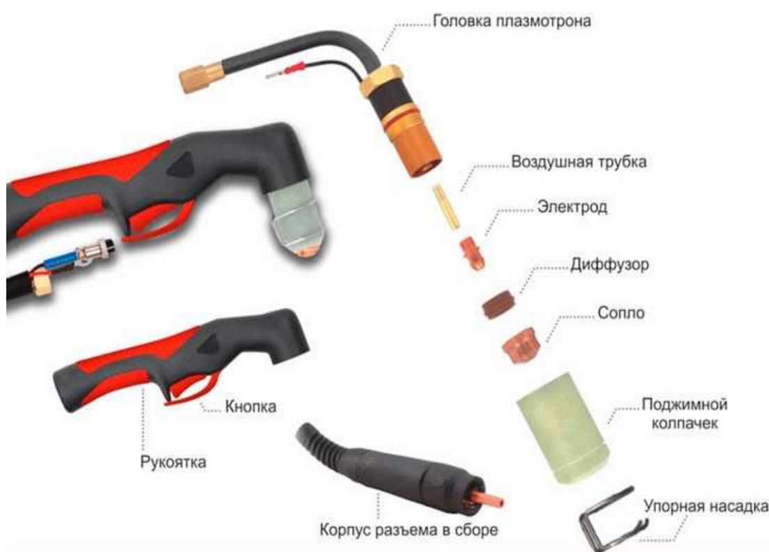
Рисунок 5.9 – Основные элементы плазмотрона для ручной резки
