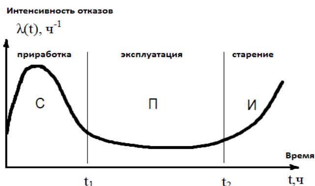
Рисунок 9.1 – Зависимость интенсивности отказов от времени
