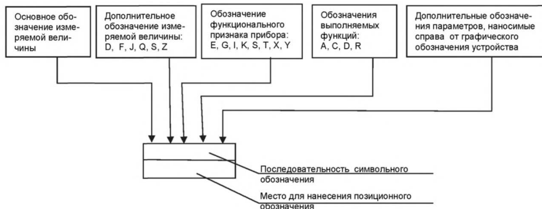
Рисунок 6.2 – Принцип построение условного обозначения прибора
