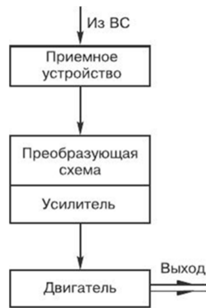
Рисунок 7.17 – Исполнительное устройство с разомкнутым контуром управления
