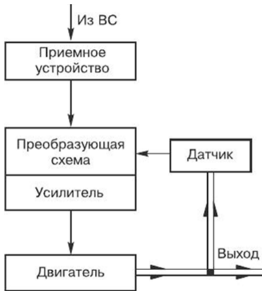
Рисунок 7.16 – Исполнительное устройство с замкнутым контуром управления
