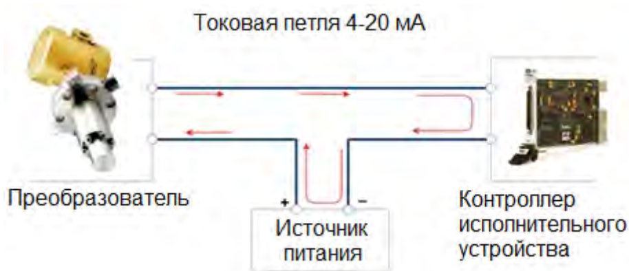
Рисунок 7.5 – Подключением датчика с выходным токовым сигналом 4–20 мА
