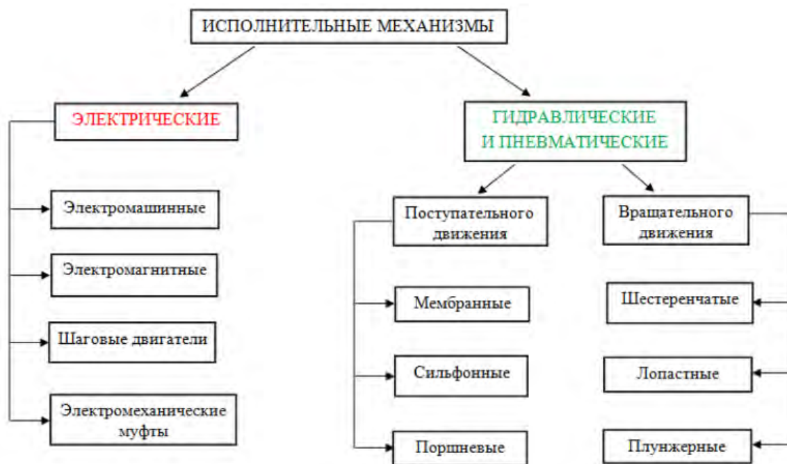
Рисунок 7.15 – Классификация исполнительных механизмов
