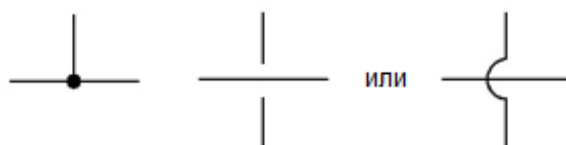
Рисунок 6.1 – Условные обозначения соединения и пересечения трубопроводов
