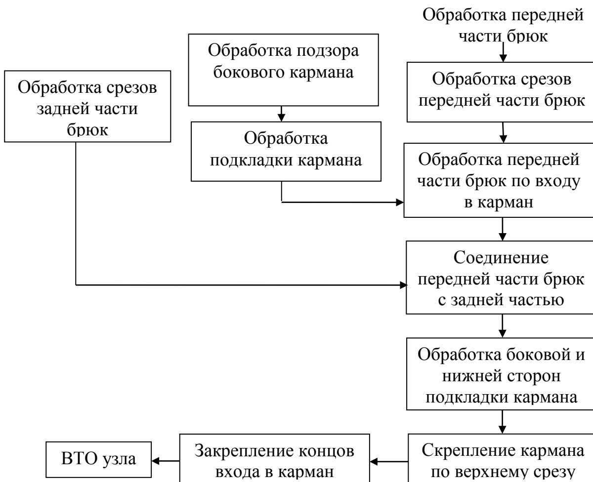
Рисунок 4.1 – Блок-схема обработки непрорезного кармана, расположенного наклонно к боковому шву брюк
