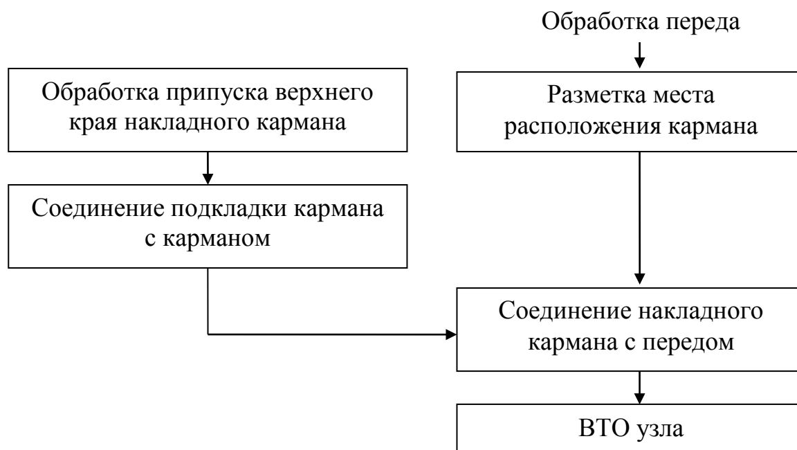
Рисунок 5.1 – Блок-схема обработки бокового накладного кармана, соединяемого с изделием накладным швом
