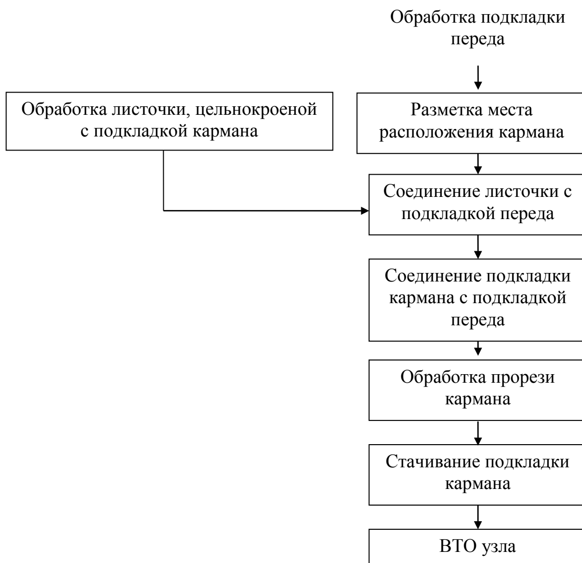
Рисунок 6.1 – Блок-схема обработки внутреннего прорезного кармана с листочкой из подкладочной ткани
