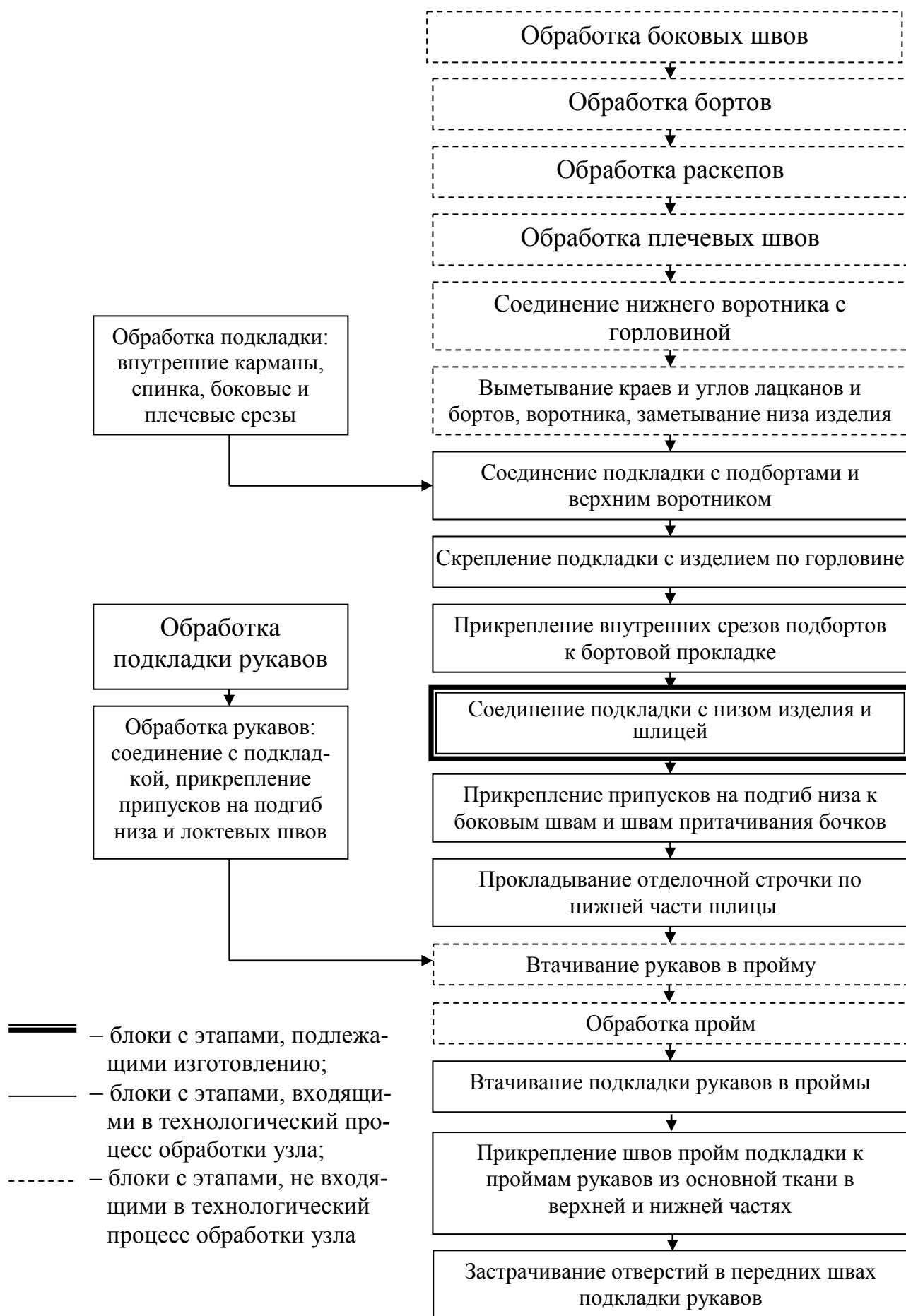
Рисунок 10.1 – Блок-схема обработки подкладки в мужском пиджаке
