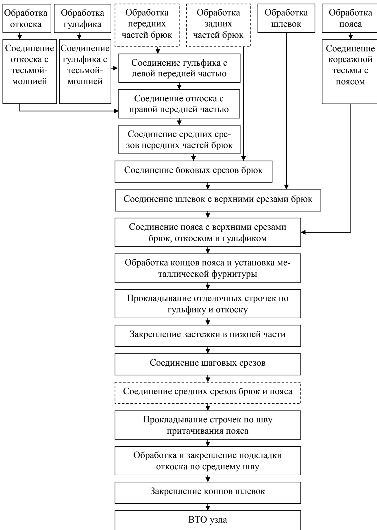
Рисунок 11.1 – Блок-схема обработки верхних краев брюк с застежкой на тесьму-молнию и пояса с корсажной лентой
