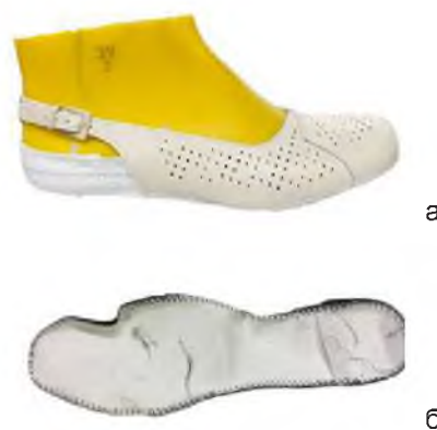
Рисунок 2 – Обувь строчечно-литьевого метода крепления: а – объемная заготовка; б – втачная стелька, соединенная с верхом обуви
