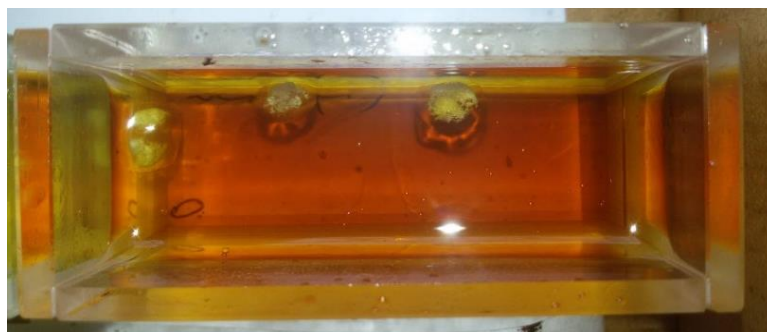
Рисунок 2 – Пример набухания СБС-полимеров линейного строения в ЛТМ
