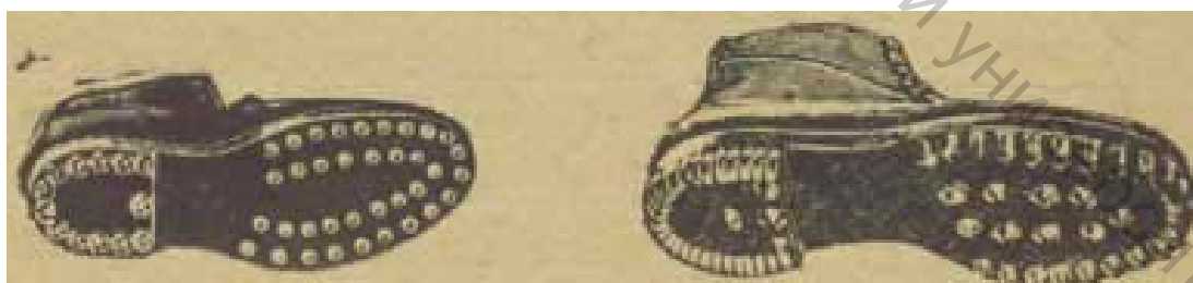
Рисунок 15.1 – Расположение гвоздей на подошве ботинка
