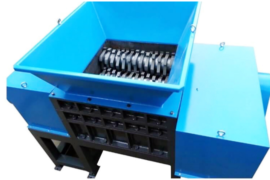
Рисунок 4 – Двухвальный шредер для измельчения древесины
