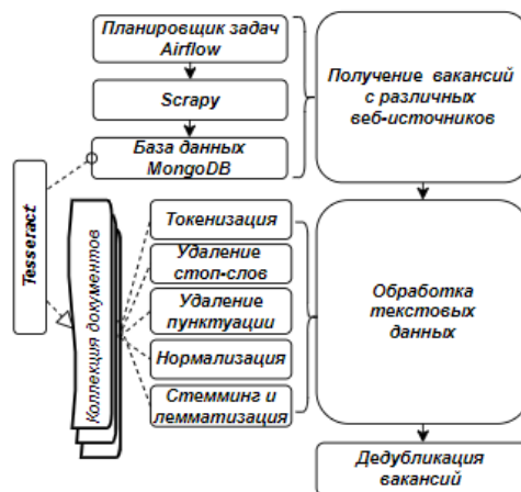
Рисунок 2.4 – Архитектура аналитической платформы сбора и обработки данных
