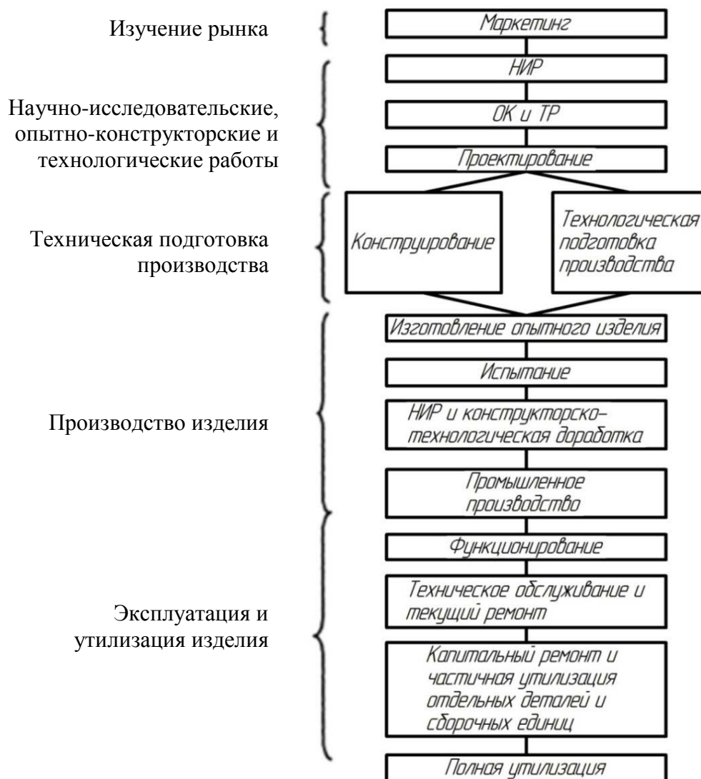
Рисунок 1.1 – Жизненный цикл машиностроительного изделия
