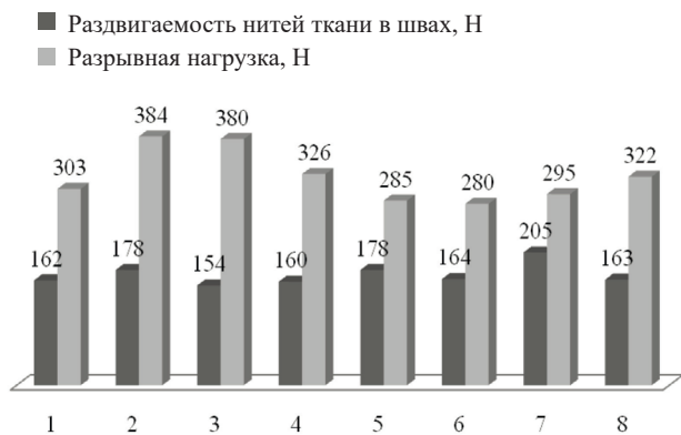
Рисунок 2 – Зависимость раздвигаемости нитей ткани в швах и разрывной нагрузки при использовании швейной иглы с заточкой острия «лопатка» (S)
