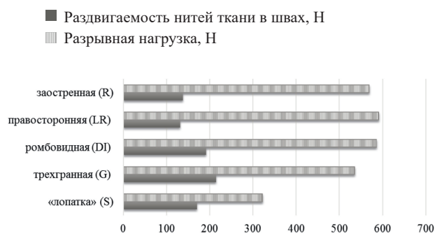
Рисунок 7 – Зависимость раздвигаемости нитей ткани в швах и разрывной нагрузки при использовании различных игл
