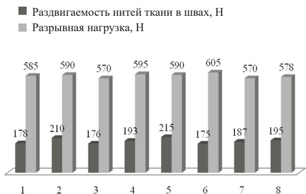
Рисунок 4 – Зависимость раздвигаемости нитей ткани в швах и разрывной нагрузки при использовании швейной иглы с ромбовидной (DI) заточкой острия
