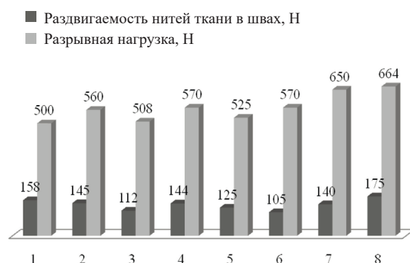
Рисунок 6 – Зависимость раздвигаемости нитей ткани в швах и разрывной нагрузки при использовании швейной иглы с заостренной (R) заточкой острия
