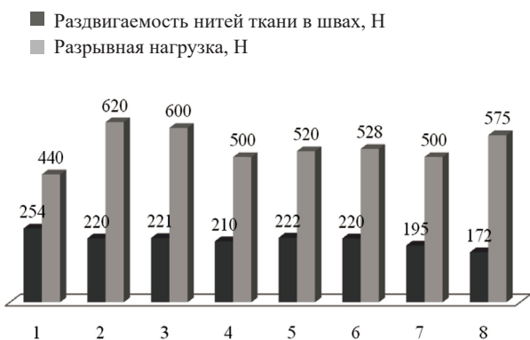
Рисунок 3 – Зависимость раздвигаемости нитей ткани в швах и разрывной нагрузки при использовании швейной иглы с трехгранной (G) заточкой острия
