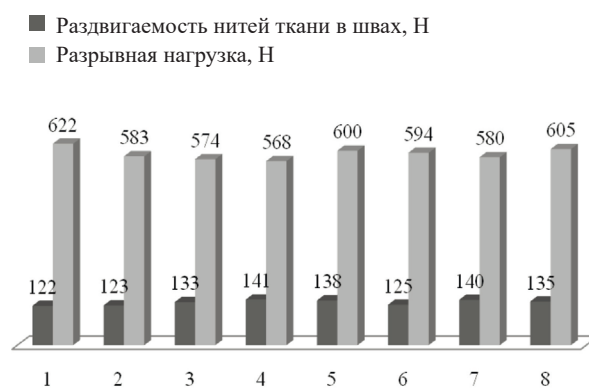
Рисунок 5 – Зависимость раздвигаемости нитей ткани в швах и разрывной нагрузки при использовании швейной иглы с правосторонней (LR) заточкой острия
