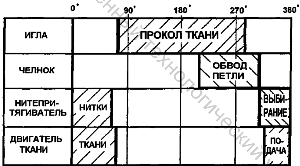
Рисунок 8.5 – Циклограмма швейной машины
