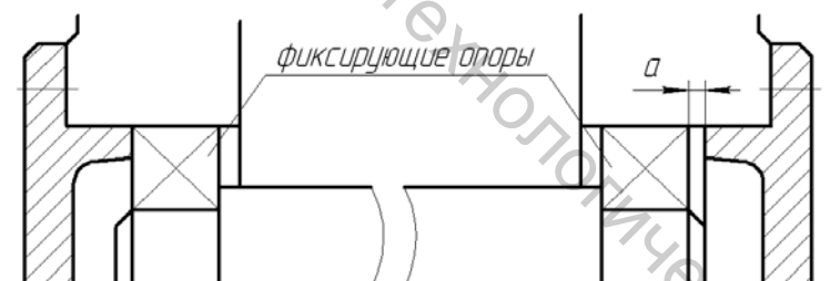
Рисунок 19.10 – Установка подшипников в “распор”
