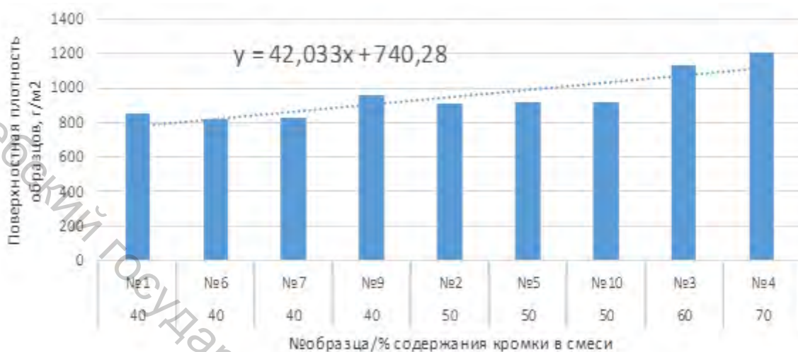
Рисунок 3.31 – Диаграмма зависимости поверхностной плотности от процентного содержания в смеси кромки грунтовой ткани
