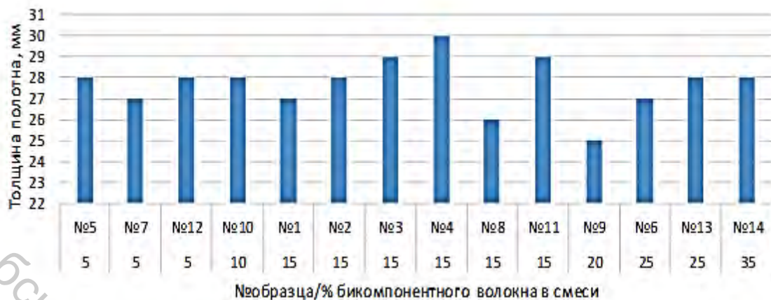
Рисунок 3.25 – Диаграмма зависимости толщины от процента содержания бикомпонентного волокна в смеси
