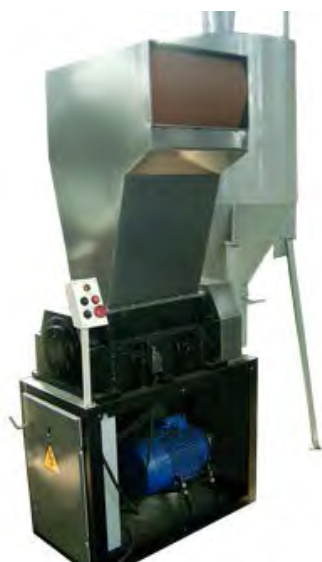
Рисунок 2.9 – Универсальный роторный измельчитель ИУР 200
