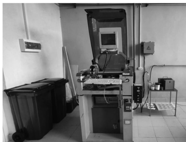
Рис. 3. Автоматизированное рабочее место для нанесения клея на пленочные шкалы
