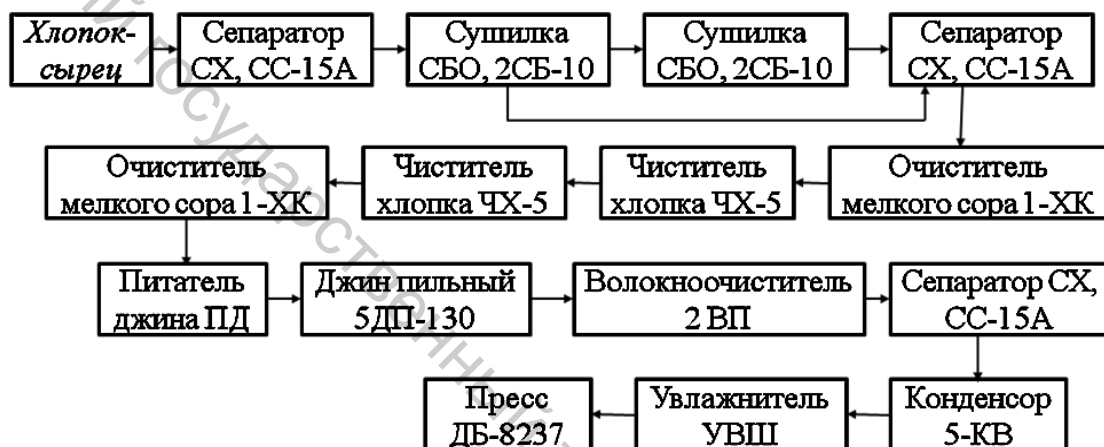
Рисунок 2.6 – Схема завода пыльного волокноотделения
