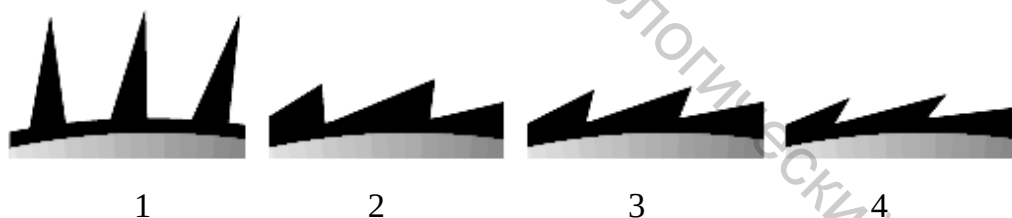
Рисунок 3.29 – Внешний вид гарнитуры на барабанах машины Cleanomat CL-C4 (1–4 – номер барабана в направлении движения волокнистого материала)
