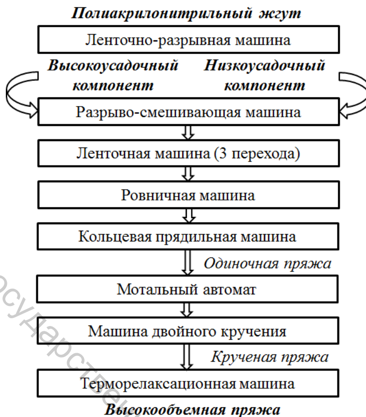
Рисунок 5.20 – Схема получения высокообъемной пряжи на ОАО «Полесье»
