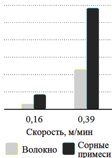
Рисунок 4.41 – Влияние скорости шляпок на количество и состав шляпочного очеса
