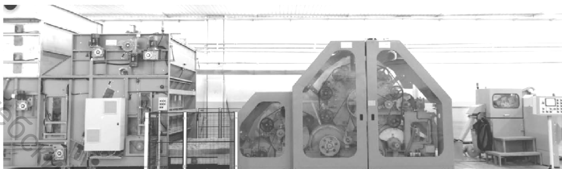
Рисунок 4.48 – Чесальная машина фирмы N. Schlumberger модели 302 с питателем и лентоукладчиком
