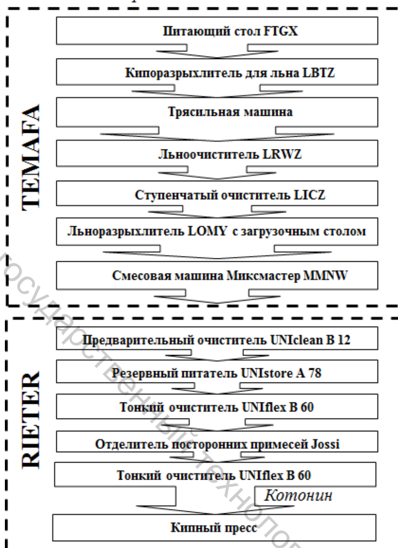
Рисунок 3.70 – Линия котонизации, скомпонованная из оборудования фирм Temafa и Rieter
