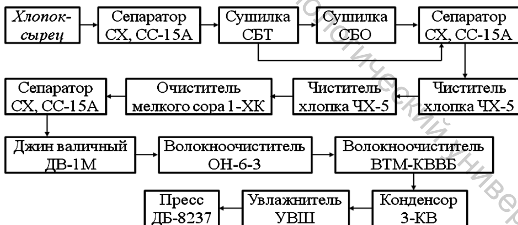
Рисунок 2.7 – Схема завода валичного волокноотделения
