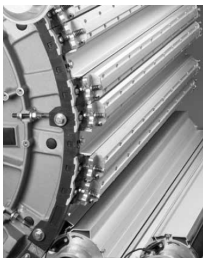
Рисунок 4.30 – Зоны установки неподвижных шляпок различных чесальных машин
