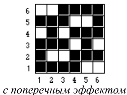
Рисунок 23 – Рубчиковые переплетения (закрепляющее переплетение - саржа 1/2)
