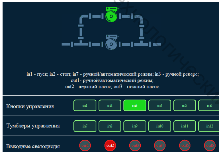
Рисунок 8.7 – Смена работы насосов в ручном режиме
