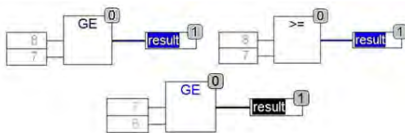
Рисунок 5.10 – Оператор сравнения «Больше или равно»
