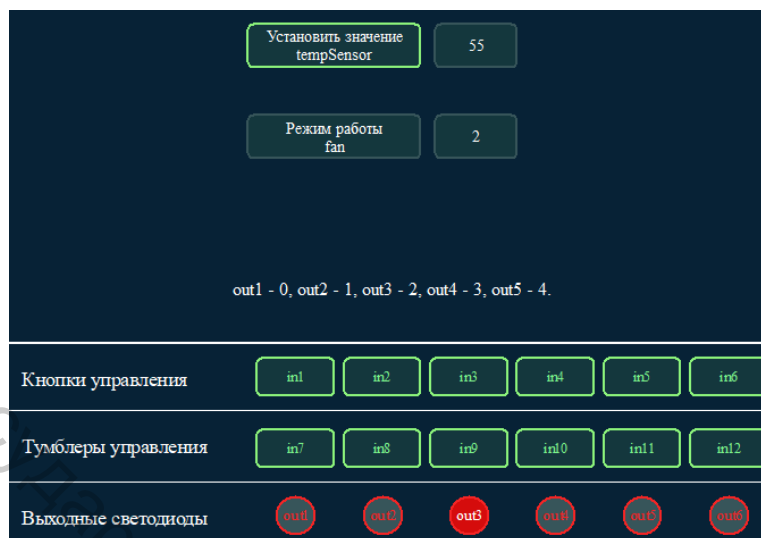
Рисунок 5.15 – Режим работы вентилятора при температуре 55 °С
