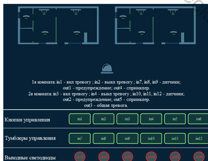
Рисунок 8.9 – Управление пожарной системой извещения объекта
