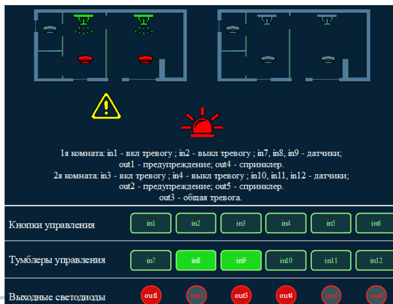
Рисунок 8.10 – Включение общей тревоги при срабатывании 2 и более датчиков в 1-й комнате
