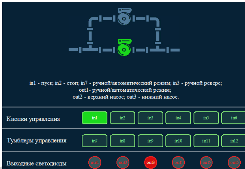
Рисунок 8.6 – Запуск системы в ручном режиме
