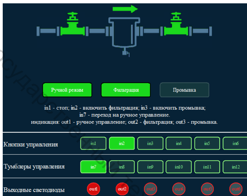
Рисунок 7.6 – Выбор режима работы «Фильтрация» в «Ручном режиме»
