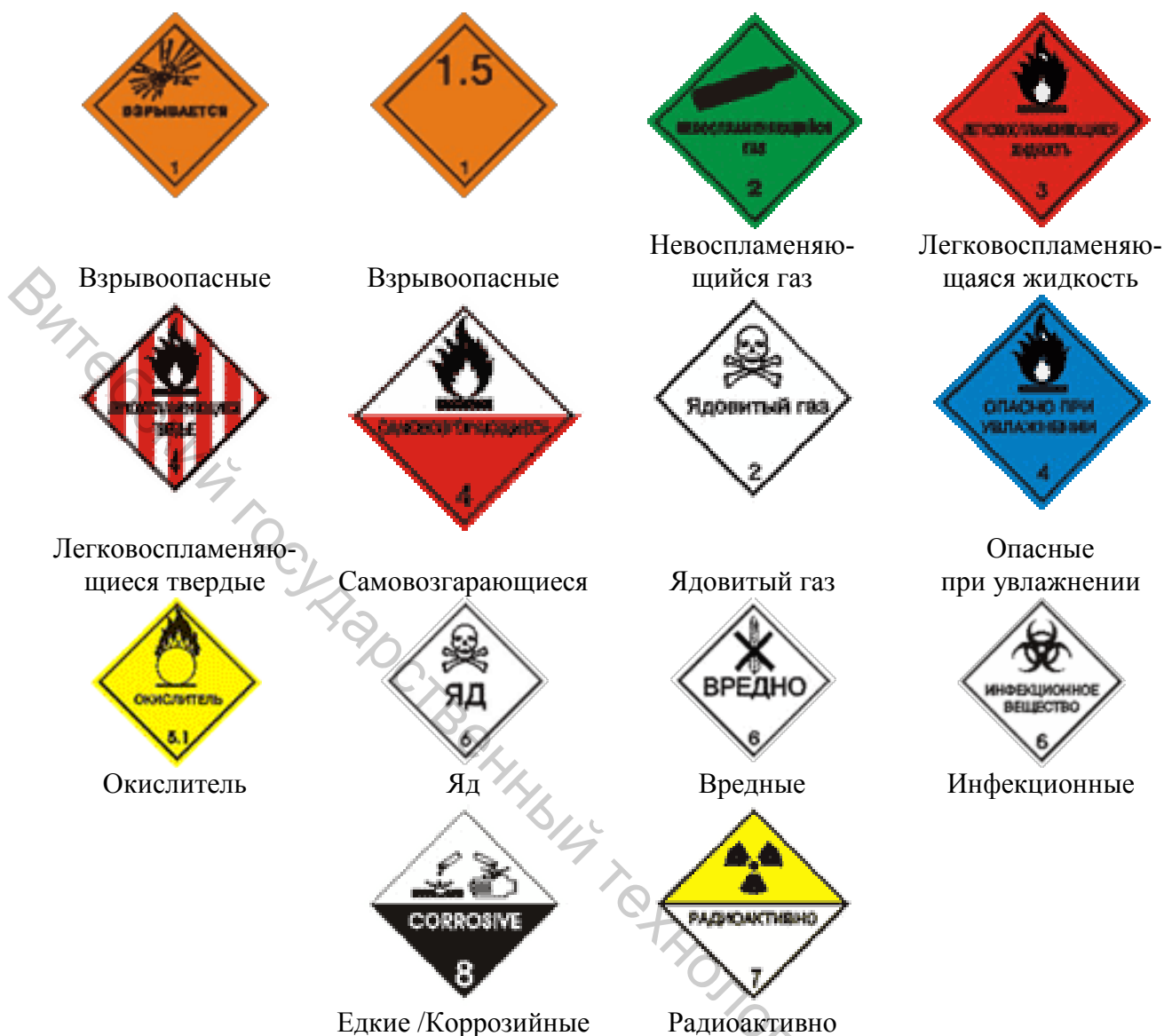
Рисунок 10.4 – Предупредительная маркировка в соответствии с ГОСТ 19433-88
