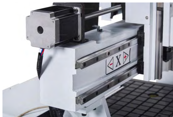
Рисунок 2.17 – Линейные направляющие и ШВП: а – оси X, Z; б – ШВП оси X с серводвигателем
