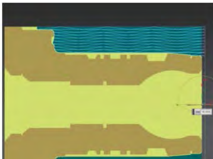
Рисунок 3.30 – Траектория движения резца в стратегии «Зиг с погружением»
