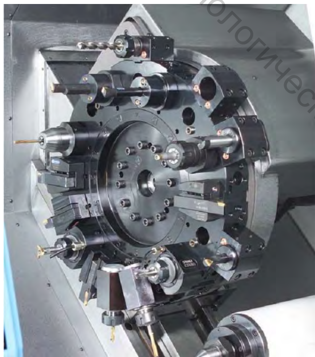
Рисунок 2.9 – Пример размещения револьверной головки с приводными и неприводными инструментами на станке с ЧПУ
