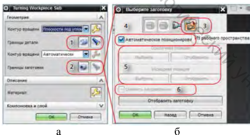
Рисунок 3.74 – Меню создания заготовки для обработки в контршпинделе: а – задание границы детали и заготовки; б – передача заготовки в контршпиндель
