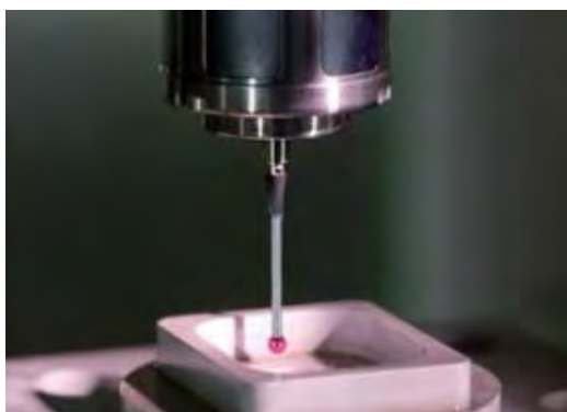
Рисунок 3.112 – Пример использования измерительного датчика для контроля положения детали на станке
