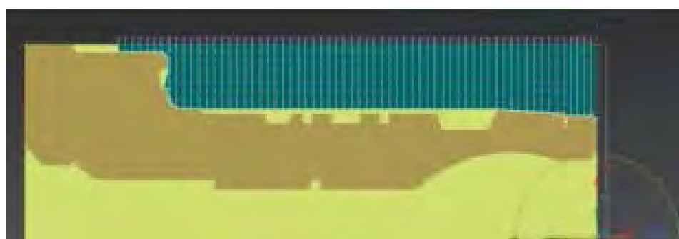
Рисунок 3.32 – Траектория движения резца в стратегии «Погружение зиг»
