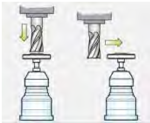
Рисунок 3.117 – Использование контактного датчика для измерения длины и радиуса инструмента
