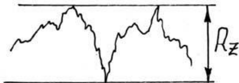
Рис. 12.16. Микронеровности от механической обработки
