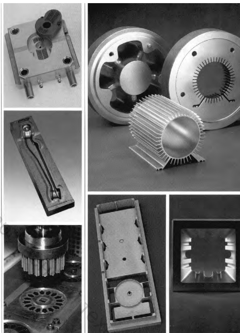
Рис. 1.19. Примеры обработки деталей сложной формы: электрода-инструмента для изготовления полости, формы для изготовления художественных изделий, матрицы и пуансона пробивного штампа, литейной оснастки для выдавливания корпуса электродвигателя, вытяжной формы, экструзионной матрицы
