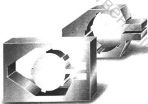
Рис.1.24. Преимущество вырезной обработки – уменьшение отходов (вверху – деталь получена обработкой резанием)
