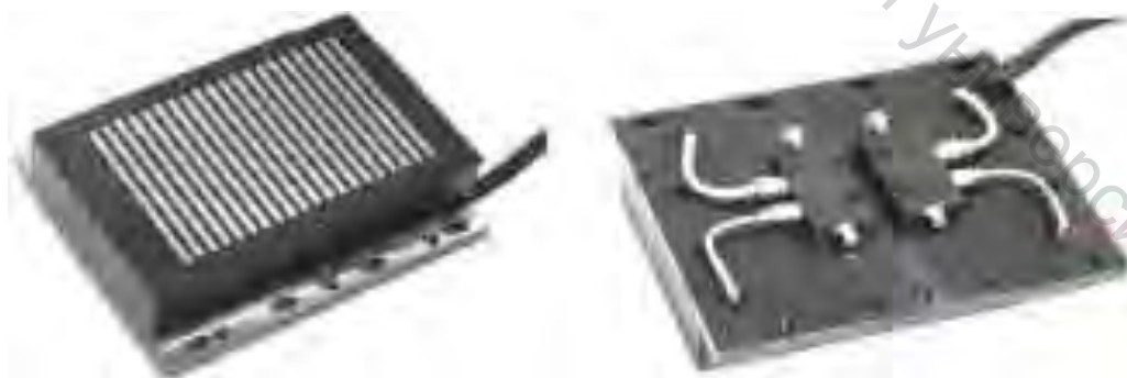
Рис. 1.48. Общий вид электромагнитов статора оси Z с внутренней и внешней стороны
