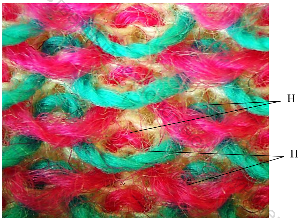
Рисунок 3.82 – Визуальное изображение структуры изнаночной стороны кулирного трикотажа с подкладочными футерными нитями
