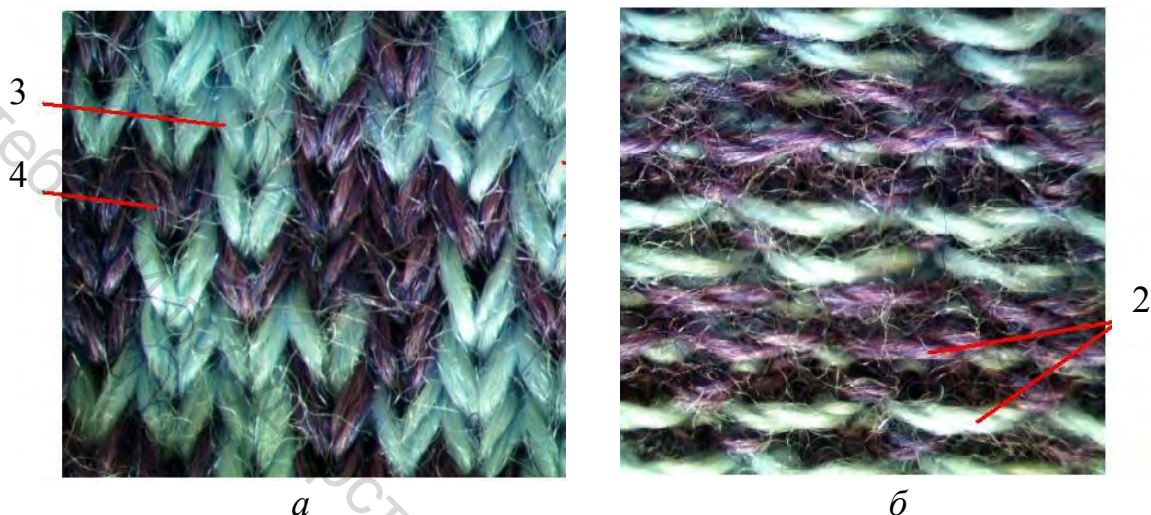
Рисунок 3.63 – Укрупненное визуальное изображение структуры кулирного одинарного регулярного двухцветного трикотажа жаккардовых переплетений: a – лицевая сторона; б – изнаночная сторона
