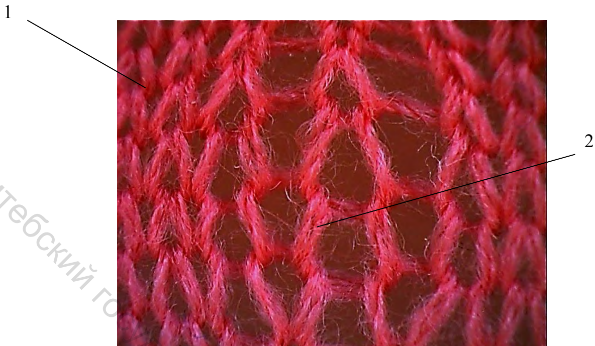
Рисунок 3.51 – Визуальное изображение лицевой стороны одинарного трикотажа неравномерных (глазковых) переплетений
