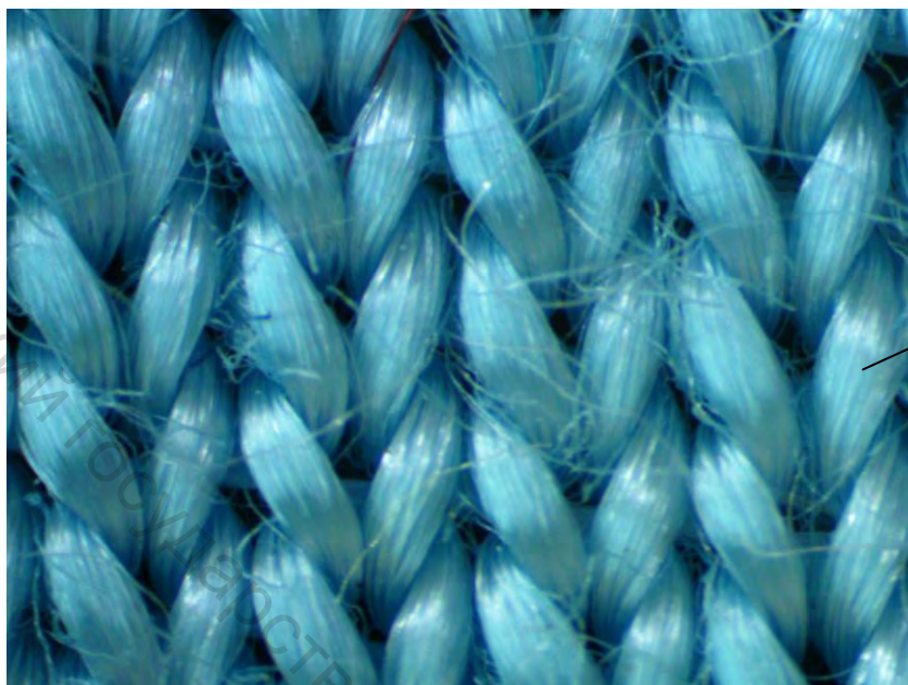
Рисунок 3.15 – Визуальное изображение структуры лицевой стороны кулирного одинарного гладкого трикотажа платированных переплетений
