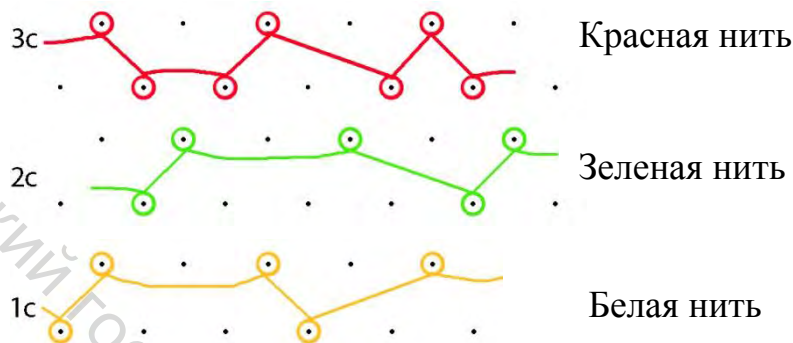
Рисунок 3.70 – Графическая запись двойного кулирного одностороннего трехцветного неполного нерегулярного трикотажа жаккардовых переплетений
