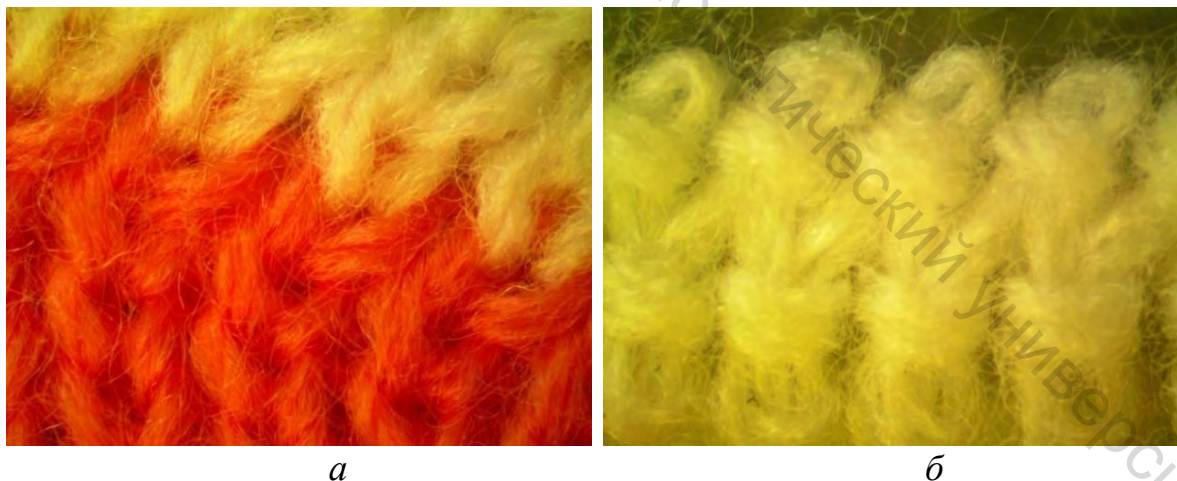
Рисунок 3.110 – Укрупненное визуальное изображение трикотажа перекрестных переплетений на базе ластика 1+1: а – правая сторона; б – последний петельный ряд
