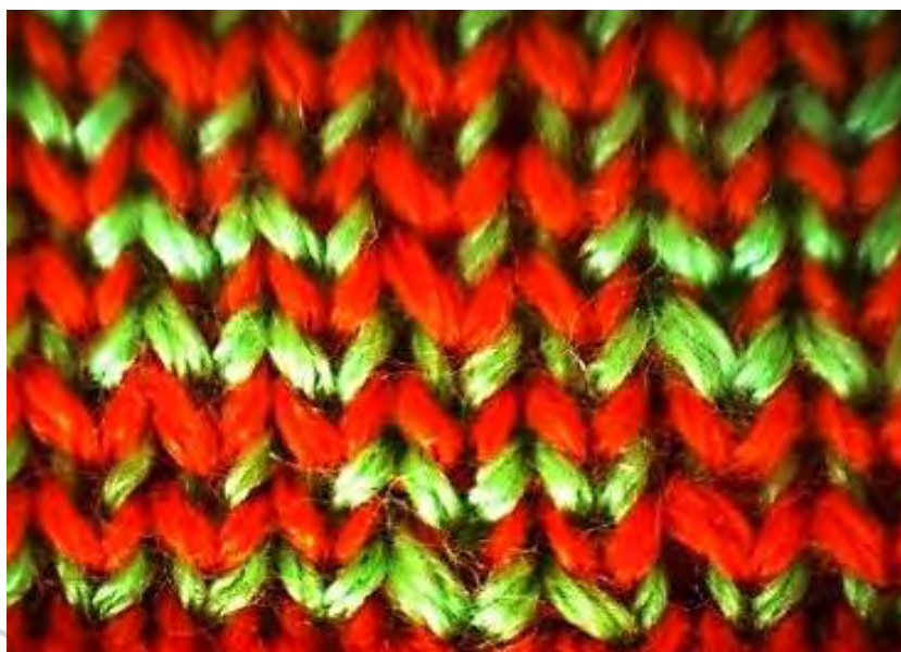
Рисунок 3.66 – Визуальное изображение структуры изнаночной стороны кулирного двойного одностороннего полного двухцветного трикотажа жаккардовых переплетений
