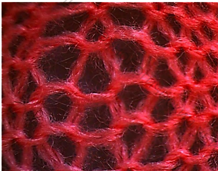
Рисунок 3.52 – Визуальное изображение изнаночной стороны одинарного трикотажа неравномерных (глазковых) переплетений
