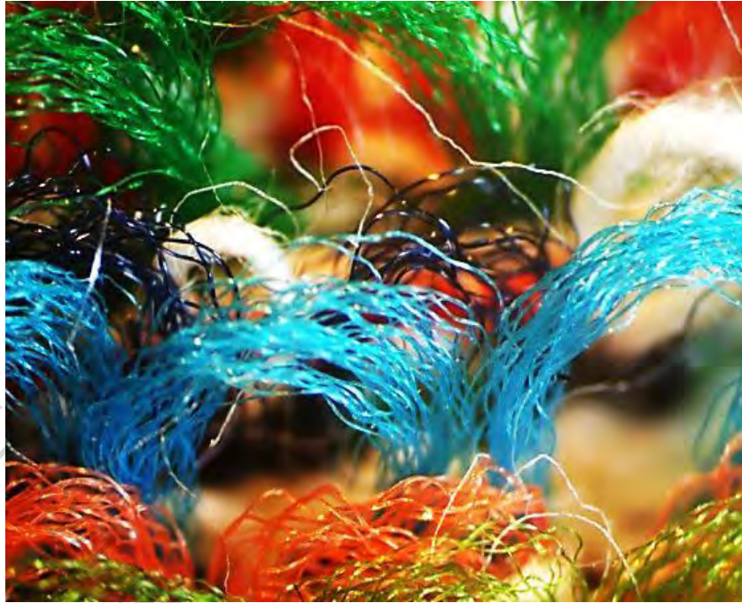
Рисунок 3.49 – Визуальное изображение структуры изнаночной стороны кулирного одностороннего изнаночного рисунчатого трикотажа плюшевых переплетений
