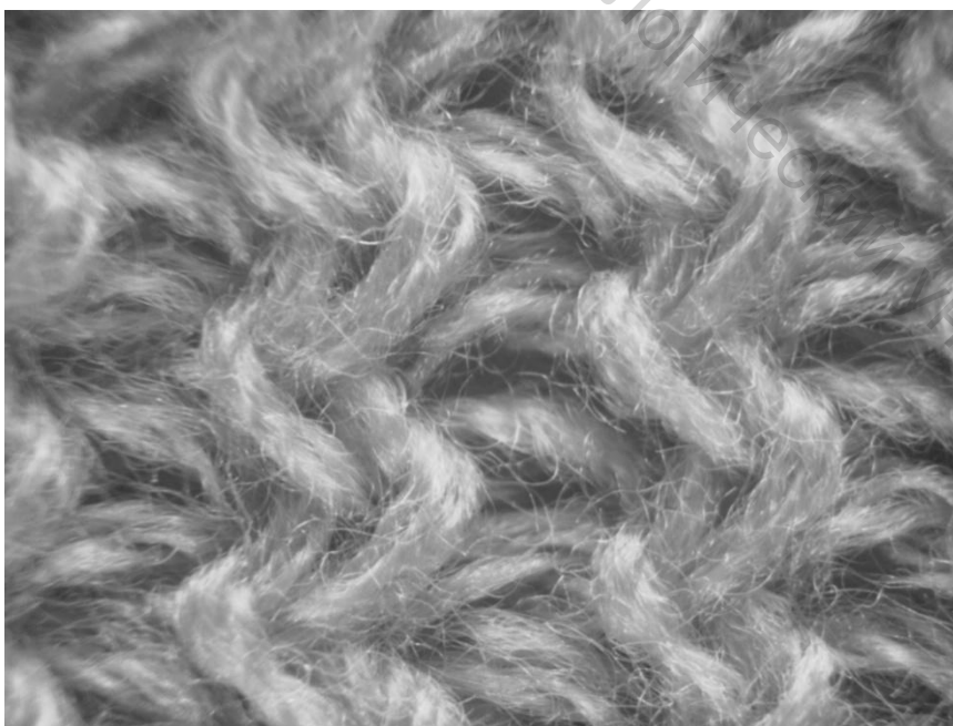
Рисунок 3.112 – Визуальное изображение общего вида левой стороны трикотажа перекрестного переплетения на базе двойного фанга
