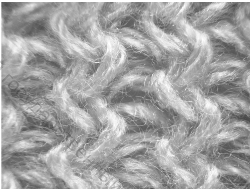
Рисунок 3.111 – Визуальное изображение общего вида правой стороны трикотажа перекрестного переплетения на базе двойного фанга
