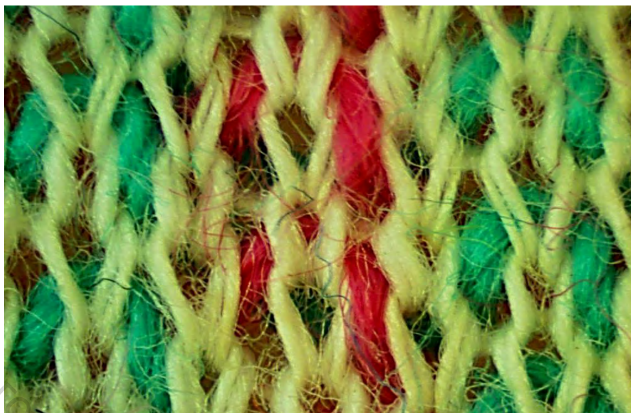
Рисунок 3.81 – Визуальное изображение структуры лицевой стороны кулирного трикотажа с подкладочными футерными нитями
