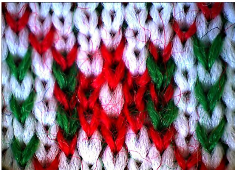
Рисунок 3.68 – Визуальное изображение структуры лицевой стороны двойного кулирного одностороннего трехцветного неполного нерегулярного трикотажа жаккардовых переплетений
