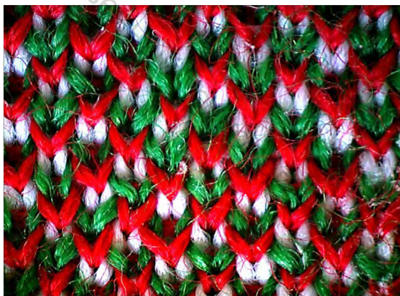
Рисунок 3.69 – Визуальное изображение структуры изнаночной стороны двойного кулирного одностороннего трехцветного неполного нерегулярного трикотажа жаккардовых переплетений
