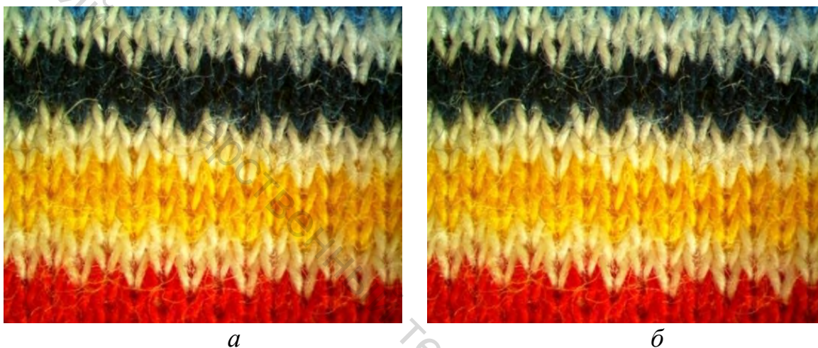
Рисунок 3.6 – Укрупненное визуальное изображение поперечносоединенного трикотажа на базе двуластика: a – правая сторона; б – левая сторона
