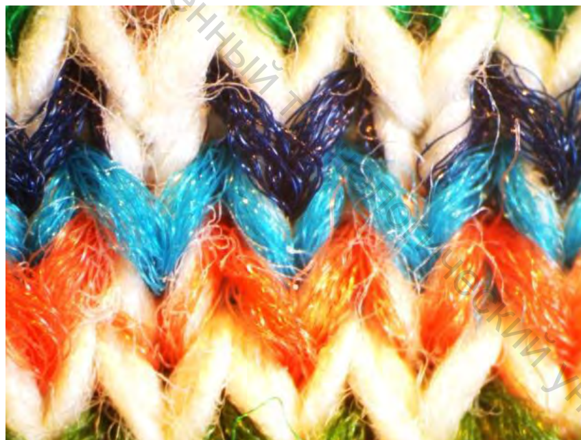
Рисунок 3.48 – Визуальное изображение структуры лицевой стороны кулирного одностороннего изнаночного рисунчатого трикотажа плюшевых переплетений
