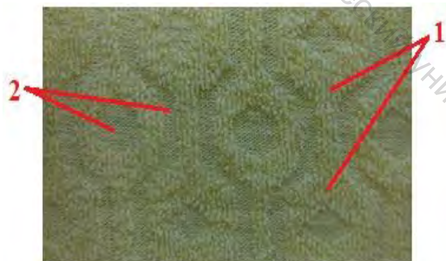
Рисунок 3.45 – Визуальное изображение общего вида изнаночной стороны рисунчатого петельного изнаночного трикотажа плюшевых переплетений
