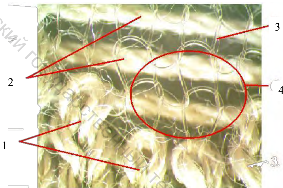
Рисунок 3.23 – Укрупненное визуальное изображение фрагмента лицевой стороны перекидного трикотажа платированных переплетений:
