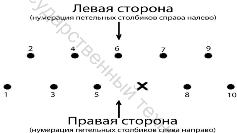
Рисунок 3.97 – Расстановка игл для получения трикотажа неполного переплетения на базе ластика 1+1
