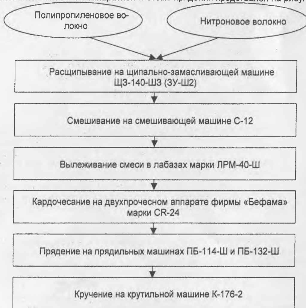
Рисунок 1 – Технологический процесс получения смешанной аппаратной пряжи с использованием полипропиленовых волокон
