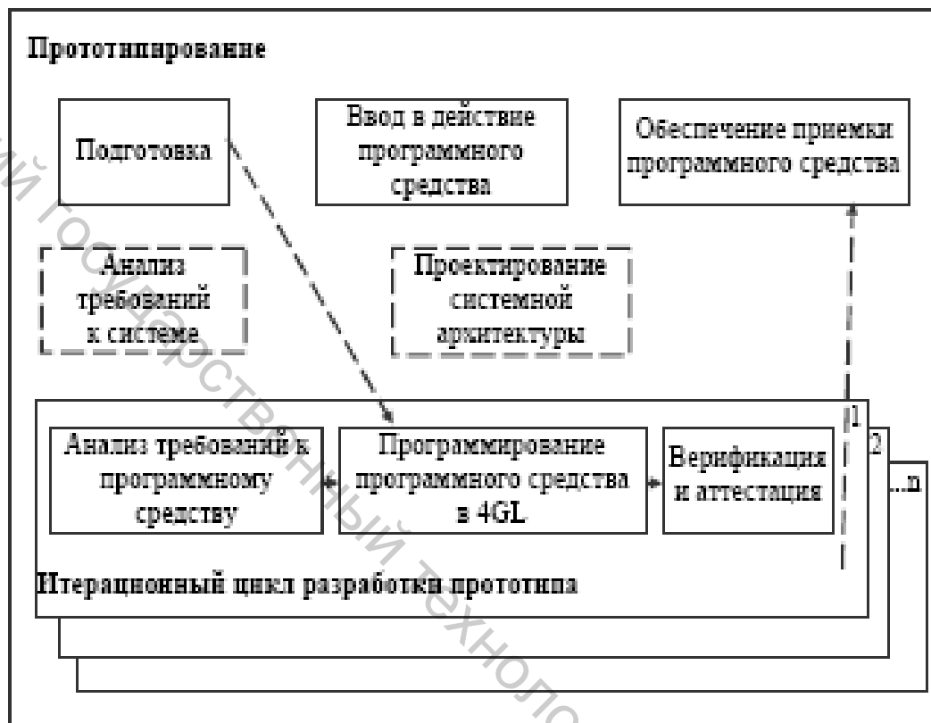
Рисунок 13 – Эволюционная модель прототипирования по ГОСТ Р ИСО/МЭК ТО 15271-2002
