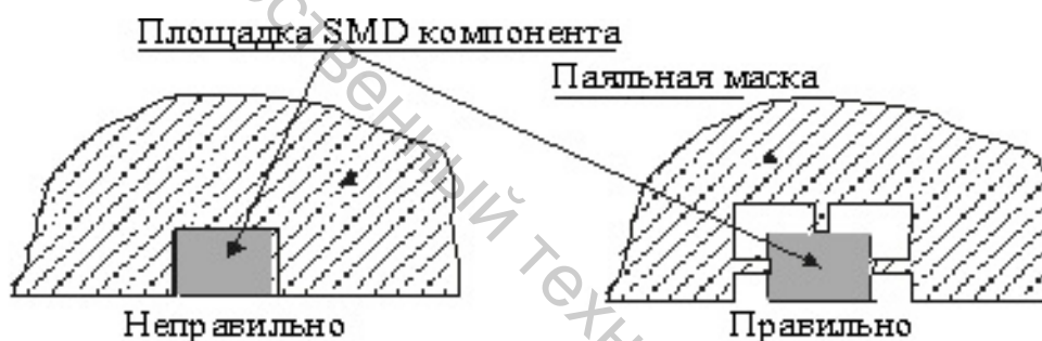
Рисунок 19 – Примеры расположения площадок SMD на больших полигонах
