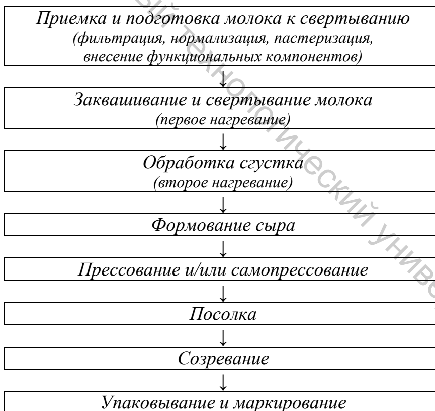
Рисунок 2.2 – Технологическая схема получения производства сыров
