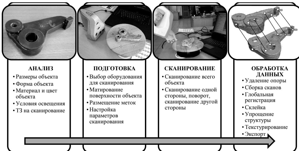
Рисунок 2 – Схема общего алгоритма сборки и обработки данных 3D-сканирования
