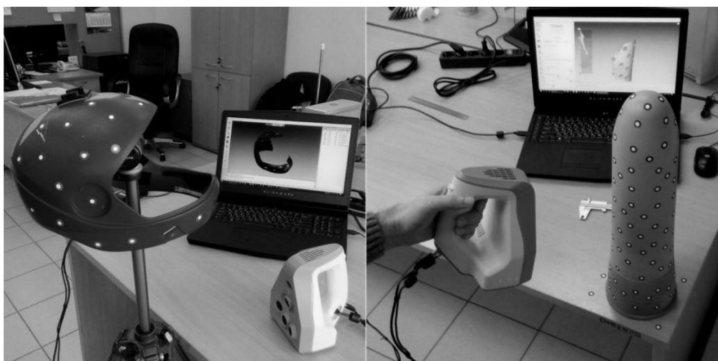
Рисунок 3 – Сканирование объектов при помощи меток
