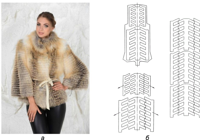
Рисунок 1 – Технология удлинения (а – вид готового изделия, б – схема раскроя)
