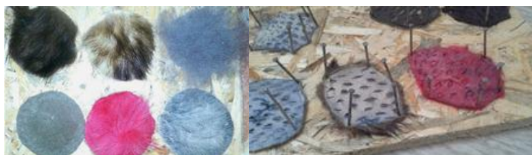
Рисунок 2 – Фрагменты этапа подготовки проб для исследования воздухопроницаемости пушно-мехового полуфабриката разных видов
