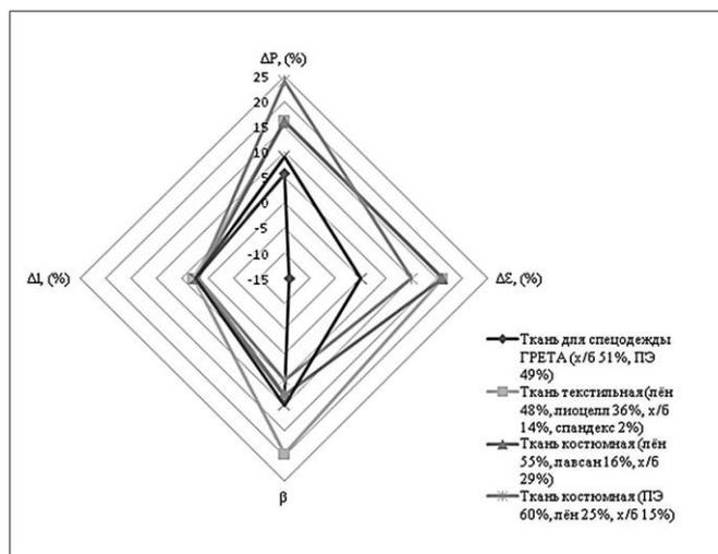
Рисунок 1 – Изменение качества образцов материала после 20000 циклов многоциклового изгиба
