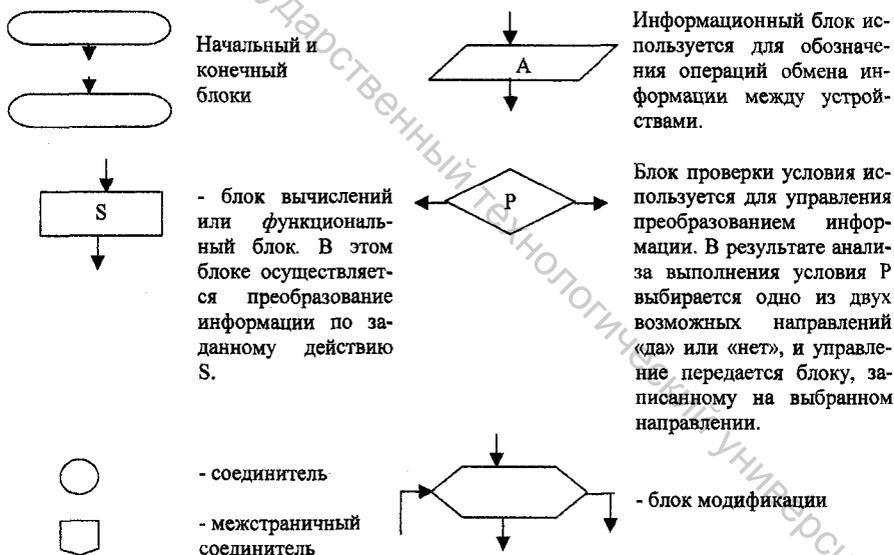
Рис. 4.1. Блоки, используемые для составления блок-схем алгоритмов
